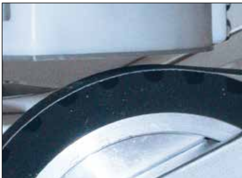
Bild 6-4 Abstand Messer zum Nass-Schleifband
