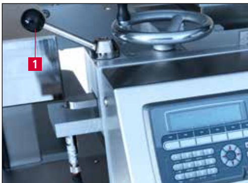
Bild 7-2 Kopierschleifeinrichtung in Wechselposition schwenken
