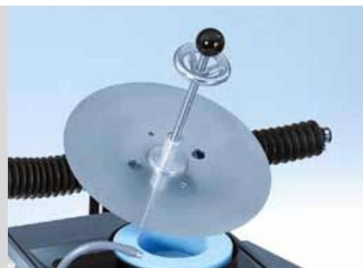
Couteaux circulaire Ø 80 - Ø 480 mm sur la meule boisseau
