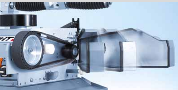
Remplacement de la bande abrasive
