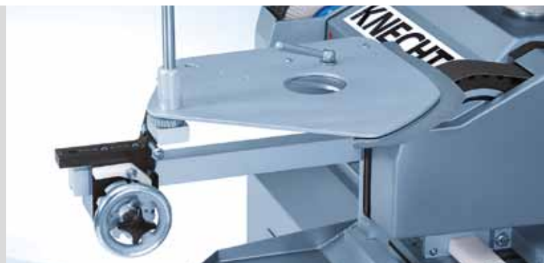
Support HV 261 pour affûtage de couteaux faucille sur bande abrasive
