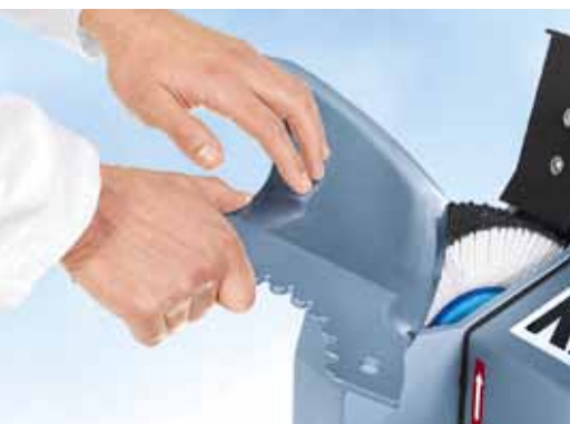
Polissage des cutters sur la meule à lamelles de finition
