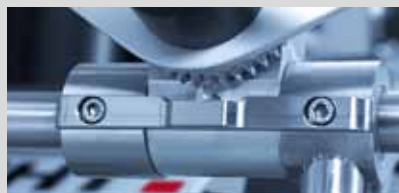
Mécanisme de blocage pour changer de couteau
