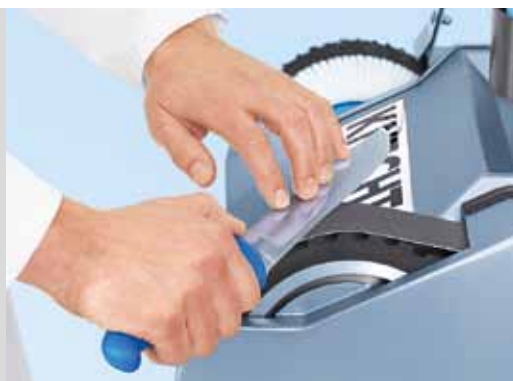
Affûtage des couteaux manuels sur la bande abrasive à eau
