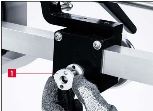
Bild 7-1 Distanzscheiben für die Schleifwinklereinstellung
