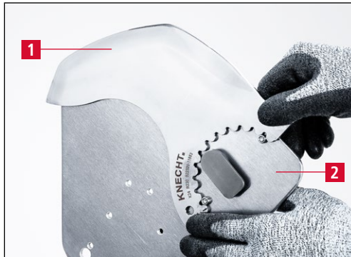
Bild 7-8 Messer auf Schleifplatte aufspannen
