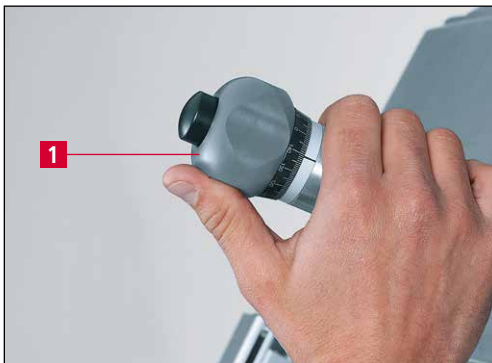
Figure 7-10 Réglage de précision «Groupe d'affûtage»
