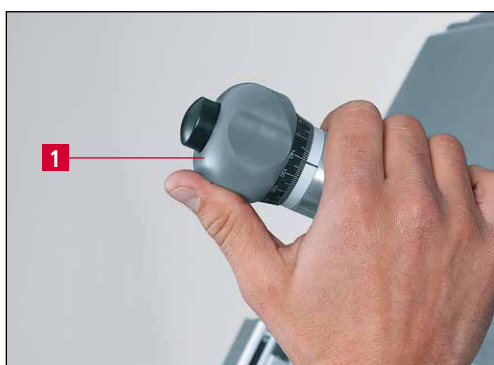
Figure 7-14 Réglage de précision «Groupe d'affûtage»
