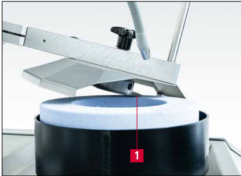
Bild 7-7 Kreismesser auf Schleifscheibe positionieren
