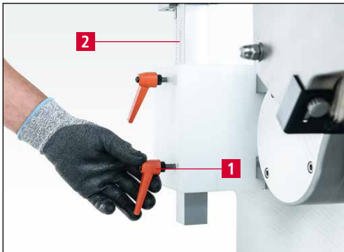
Bild 7-8 Kreismesser auf der Schleifscheibe positionieren
