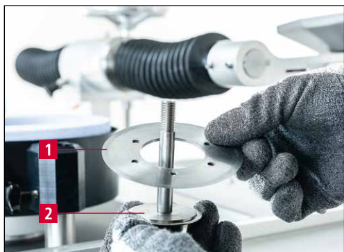
Bild 7-4 Kreismesser auf die passende Messeraufnahme legen
