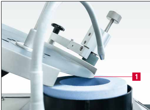
Bild 7-21 Kreismesser auf Schleifscheibe positionieren
