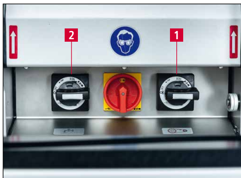
Bild 7-12 Schleifmotor und Kühlmittleinrichtung einschalten
