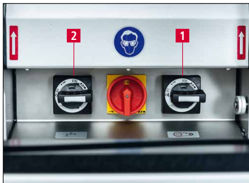
Bild 7-25 Schleifmotor und Kühlmittleinrichtung einschalten
