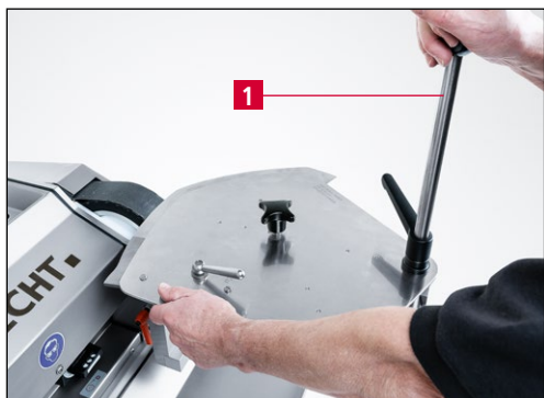
Рис. 9-21 Поворот куттерного ножа на следующий сегмент режущей кромки и заточка
