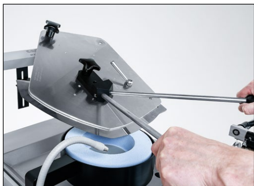
Рис. 7-20 Поворот куттерного ножа на следующий сегмент режущей кромки и заточка
