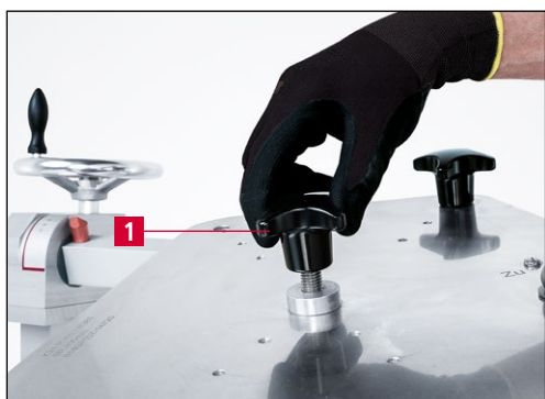
Рис. 7-6 Снятие крестообразной ручки
