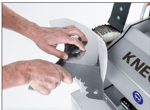
Рис. 9-22 Снятие заусенцев и полирование куттерных ножей на пластинчатой щетке
