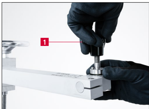
Рис. 7-2 Снятие крестообразной ручки
