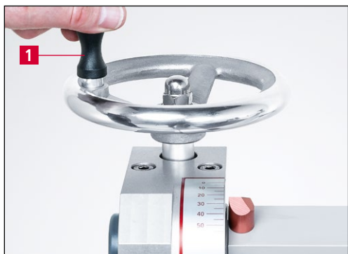
Рис. 7-19 Уменьшение угла заточки (выпуклая заточка)
