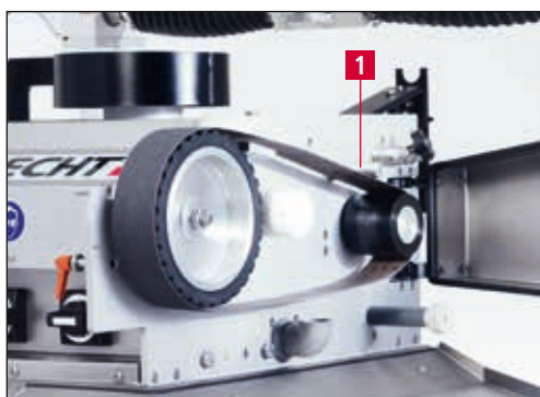
Рис. 7-14 Замена ленты для влажного шлифования
