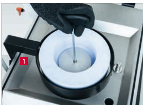
Рис. 7-12 Замена шлифовального круга
