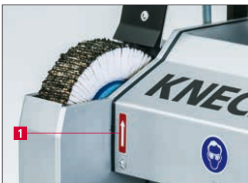
Рис. 6-2 Проверка направления вращения
