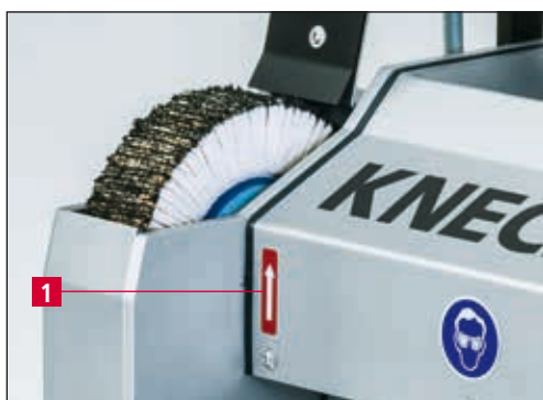
Рис. 6-2 Проверка направления вращения
