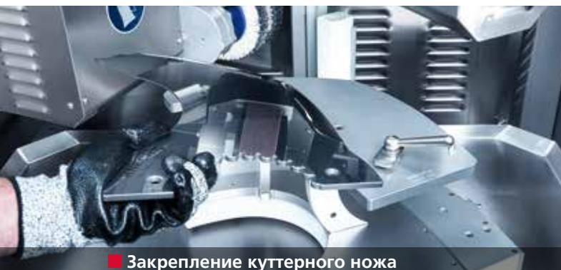
■ Закрепление куттерного ножа
