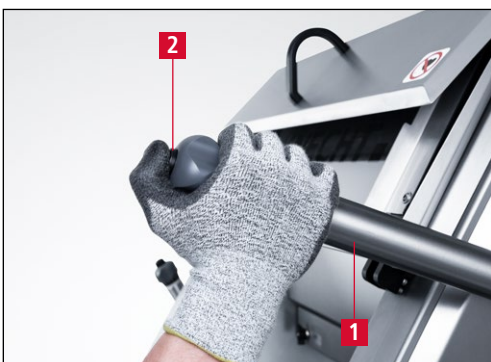
Bild 7-12 Schleifaggregat nach oben bewegen
