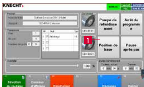
Figure 7-7 Mise en position de remplacement du disque à came
