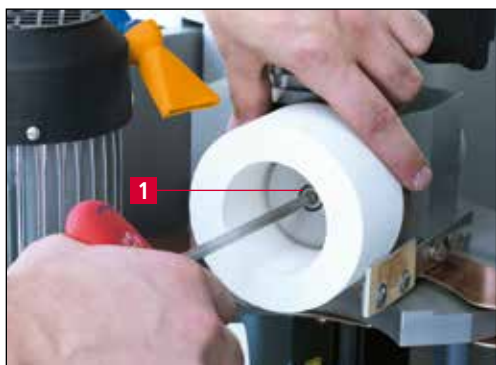
Figure 7-25 Remplacement des disques d'affûtage
