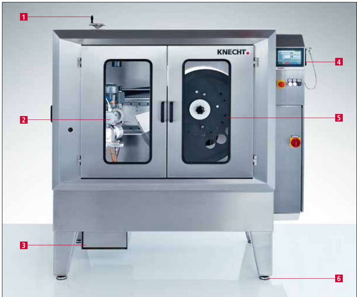
Figure 3-2 Vue d'ensemble de l'affûteuse
