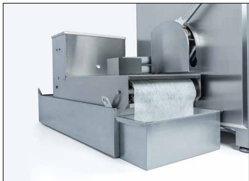
Рисунок 3-6 Система охлаждения с ленточным фильтром
