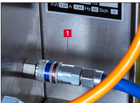
Bild 6-2 Druckluftanschluss
