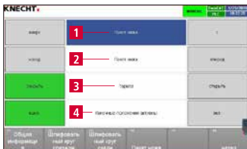
Рис. 8-12 Функции ручного режима эксплуатации «Пакет ножа»
