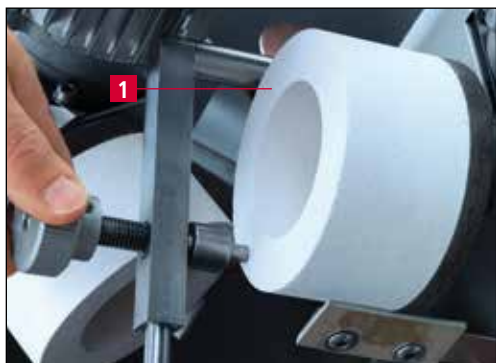
Рис. 7-23 Правка заднего шлифовального круга
