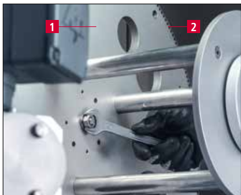
Рис. 7-5 Монтаж кулачкового диска SP 116
