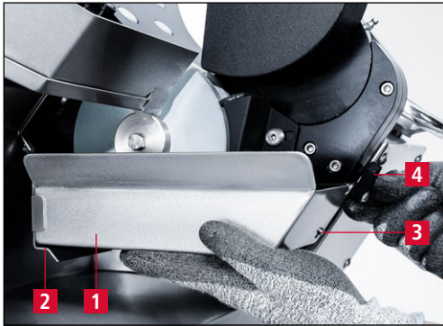
Figure 6-3 Montage de la coupelle d'eau
