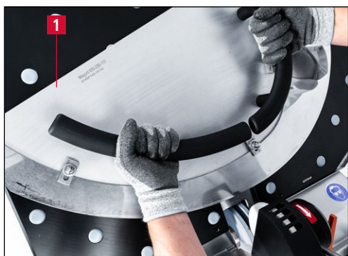
Figure 7-18 Déplacement du couteau falciforme vers le haut
