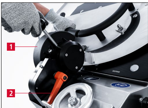
Figure 7-17 Déplacement de la meule d'ébavurage en position de rectification
