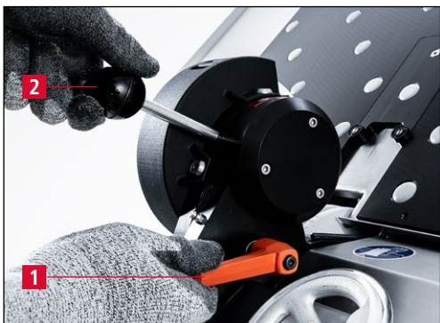
Figure 7-5 Pivotage de l'unité d'ébavurage en position finale supérieure
