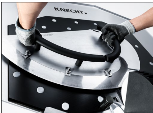
Figure 7-8 Positionnement du couteau falciforme
