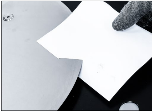
Figure 7-23 Contrôle de l'affûtage du couteau
