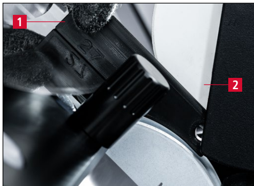
Figure 7-13 Pose de la jauge d'angle
