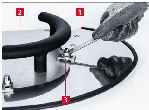
Figure 7-3 Serrage du couteau falciforme sur le gabarit d'affûtage
