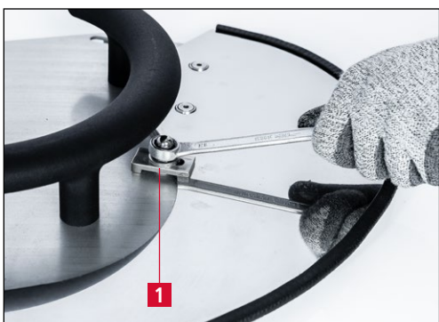
Figure 7-25 Serrage du couteau falciforme
