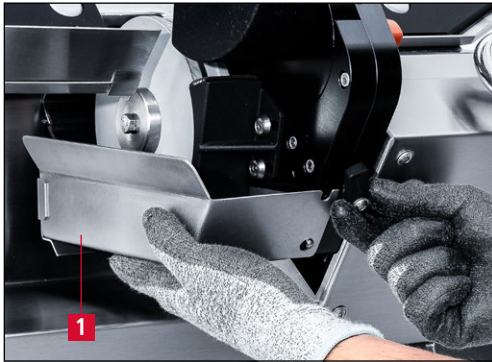
Figure 7-52 Mise en place de la coupelle d'eau
