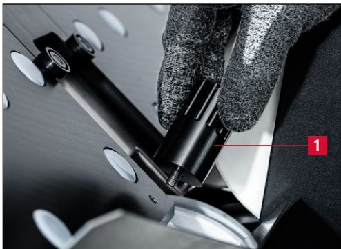
Figure 7-4 Montage de la butée de réglage
