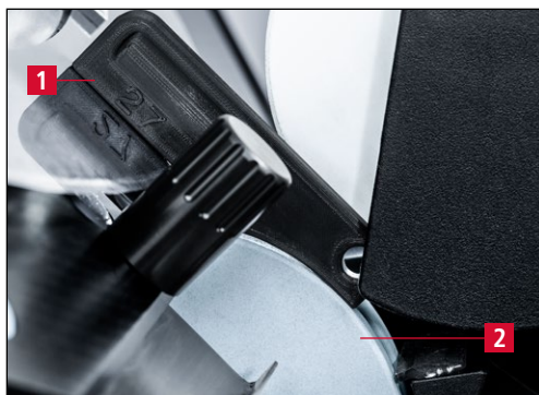
Figure 7-14 Réglage de l'angle d'affûtage
