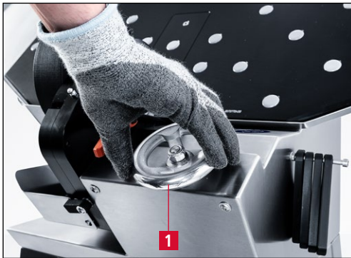
Figure 6-1 Déplacer le groupe d'affûtage en position finale supérieure
