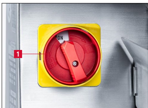
Figure 7-19 Activation de l'affûteuse
