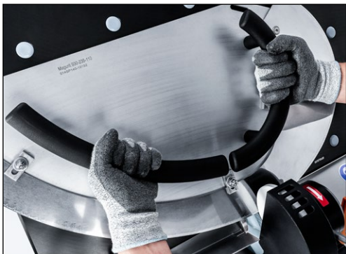
Figure 7-20 Position de départ de l'affûtage
