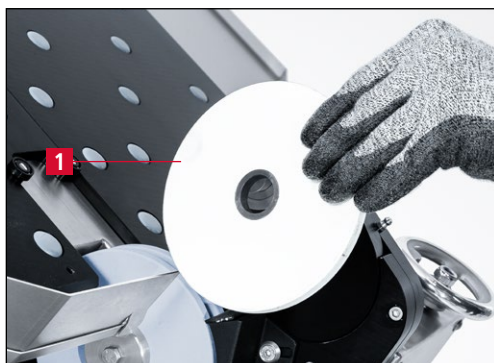
Figure 7-47 Dépose de la meule d'ébavurage et remplacement par une neuve
