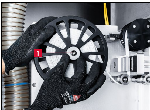
Bild 7-61 Gebrauchtes Testmedium entnehmen
