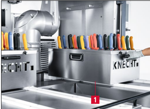
Bild 7-3 Messermagazine in die Schleifmaschine schieben
