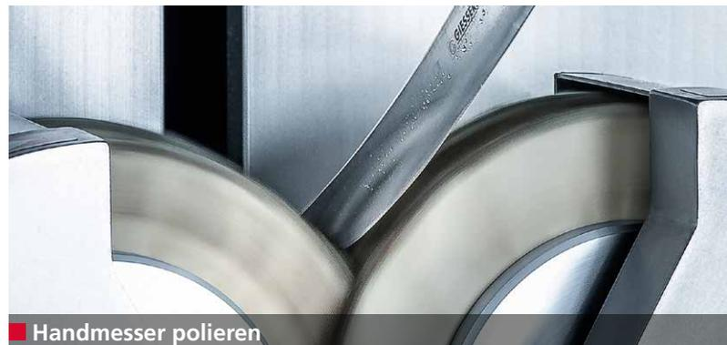
Die E 50 R schleift Handmesser unterschiedlicher Form und Größe vollautomatisch.
