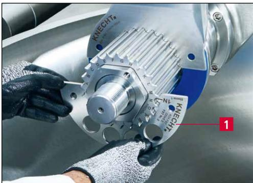
Bild 5-5 Auswuchtfüllstück (AWF) einbauen
