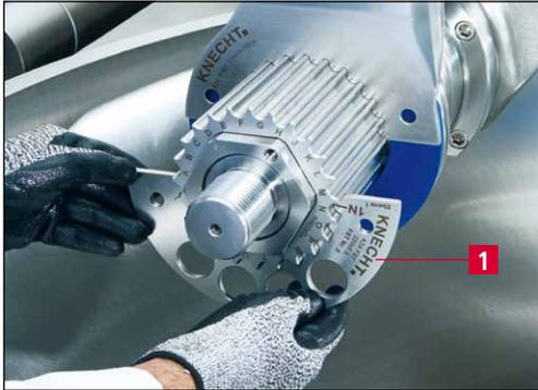
*Auswuchtfüllstück (AWF) (5-5/1) gemäß Einbauplan auf die Profilhülse schieben.*
