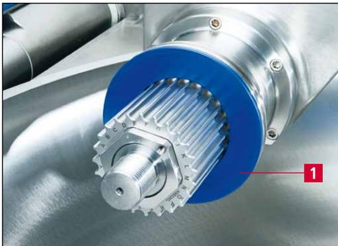
Bild 5-3 Zwischenring (ZR) einbauen
