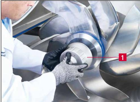
**Bild 5-12** Federspannmutter MCF 100 einbauen
