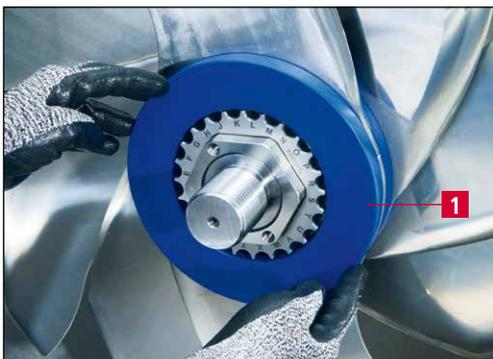
Bild 5-9 Messerpaket aufbauen
