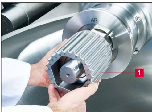
Bild 5-2 Profilhülse einbauen
