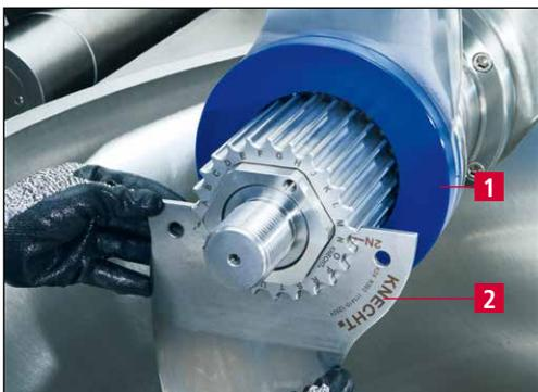
Bild 5-6 Füllstück (FST) einbauen
