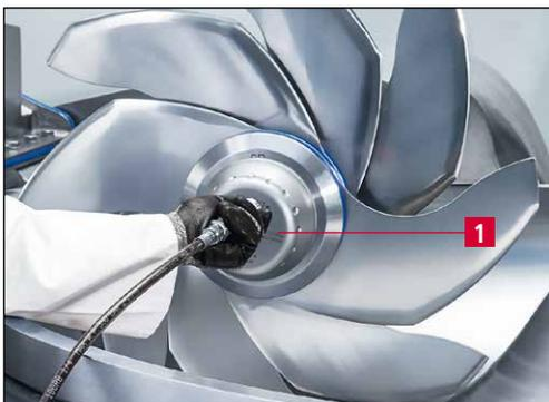
Bild 5-11 Hydromechanische Spannmutter HSM 100 einbauen
