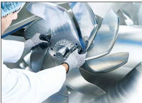
Bild 5-8 Messerpaket aufbauen
