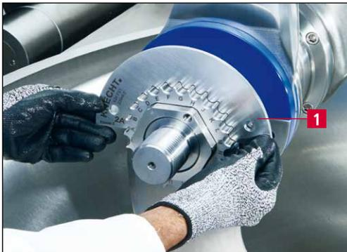
Bild 5-7 Füllstück (FST) einbauen
