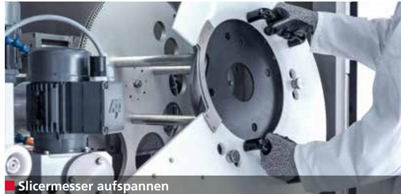
Perfekte Schnitte, schlierenfreie Oberflächen und exakt abgelegte Produkte. Die A 950 III erzeugt präzise geschliffene Slicermesser, die diese Anforderungen erfüllen.
