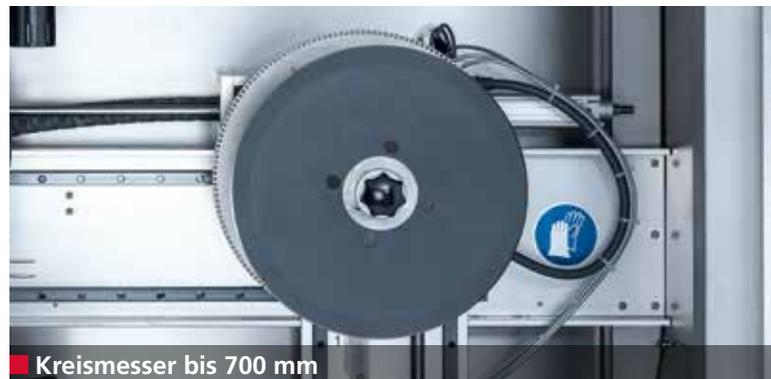
Die A 950 III schleift Kreismesser aller Fabrikate von 300 mm - 700 mm Durchmesser mit einseitigem und doppelseitigem Anschliff.
