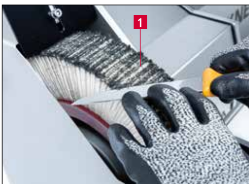
7-16. ábra A kézikés polírozása
