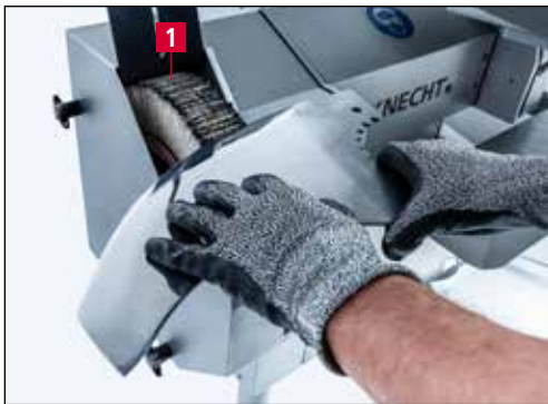
7-10. ábra Vágókés polírozása/sorjázása
