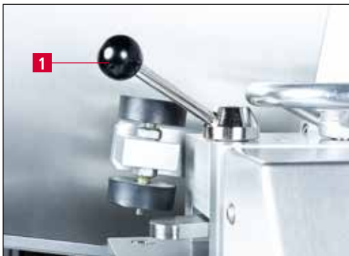
7-1. ábra A másolatcsiszoló berendezés cserepozícióba történő mozgatása
