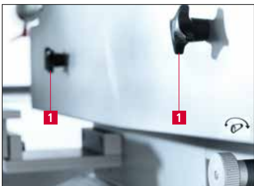
7-17. ábra A szalagvédő burkolat kinyitása
