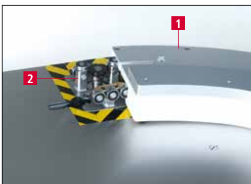
7-2. ábra A másolatcsiszoló-lemez beszerelése
