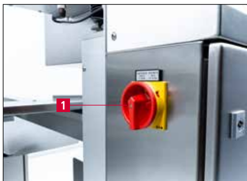
3-7. ábra Máslatcsiszoló berendezés főkapcsoló
