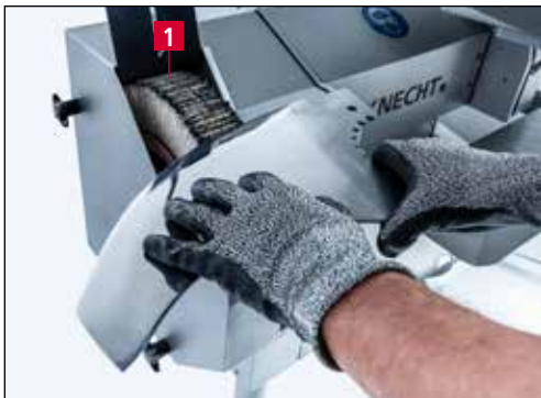
7-14. ábra Vágókés polírozása/sorjázása
