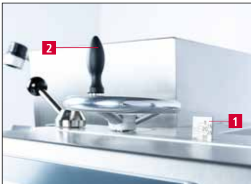
7-7. ábra A csiszolási szög beállítása
