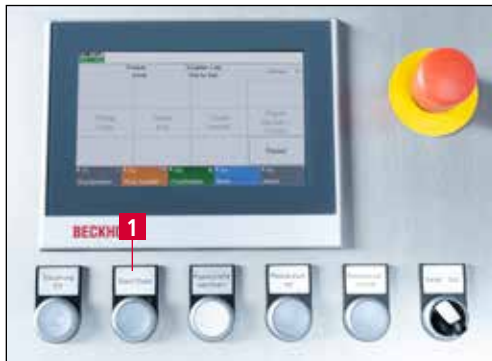
7-11. ábra A csiszolási folyamat megszakítása
