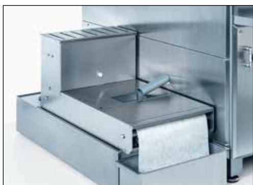
Рисунок 6-1 Заполнение системы охлаждения с ленточным фильтром
