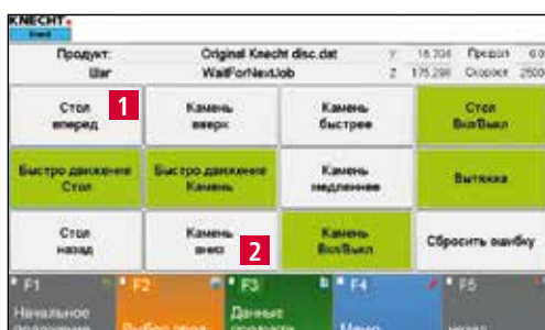
Рисунок 8-15 Перемещение стола и шлифовального круга в рабочее положение
