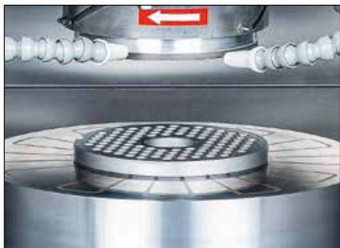
Рисунок 7-5 Решетка мясорубки на круглом столе
