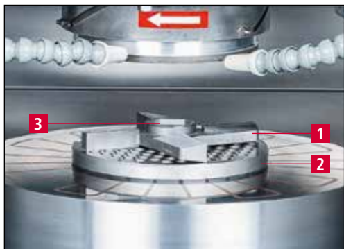
Рисунок 7-6 Шлифовка крестовидных ножей
