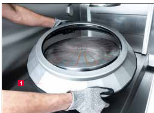
Рисунок 9-6 Извлечение маслосъемного кольца
