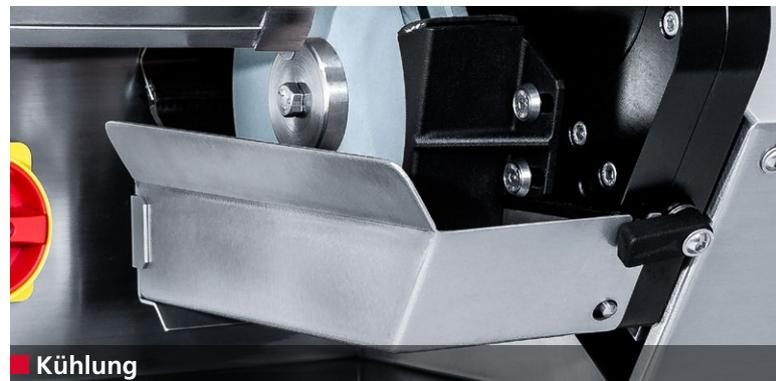
Zum Schärfen werden die Sichelmesser händisch auf einer definierten Bahn entlang der Schleifscheiben geführt. Diese Bahn wird von der Kopierschleifplatte vorgegeben und entspricht der Messerkontur. Auf diese Weise bleibt die ursprüngliche Messerform erhalten.
