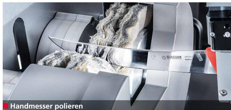
Die E 50 schleift Handmesser unterschiedlicher Form und Größe vollautomatisch. Der Messergreifarm entnimmt das Messer aus dem Magazin – die Messerform wird optisch vermessen – das Messer wird geschliffen, entgratet und poliert – der Greifarm legt das fertig bearbeitete Messer in das Magazin zurück.
