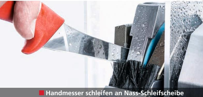
■ Handmesser schleifen an Nass-Schleifscheibe
