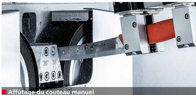
Les couteaux à main parfaitement affûtés permettent d'exécuter des coupes précises. En comparaison avec un affûtage manuel, l'utilisation de couteaux à main affûtés à l'aide de la robotique de l'E 50R permet d'obtenir un accroissement de 0,5% du rendement en viande. Pour une production de viande de 10 000 tonnes, cela représente un rendement accru de 50 000 kg.
