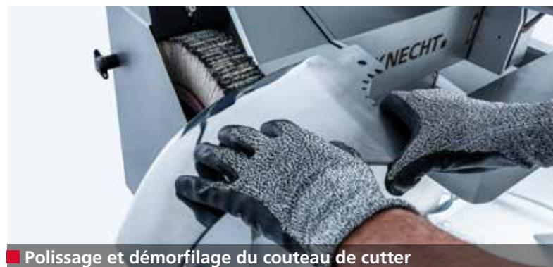
■ Polissage et démorfilage du couteau de cutter
