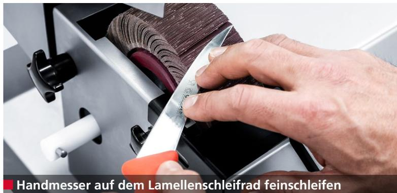
■ Handmesser auf dem Lamellenschleifrad feinschleifen
