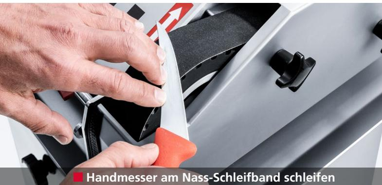
■ Handmesser am Nass-Schleifband schleifen
