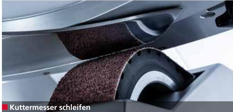
Schärfe, Schneidenwinkel, Form und Messerprofil eines Kuttermessers haben großen Einfluss auf die Qualität der produzierten Produkte.
