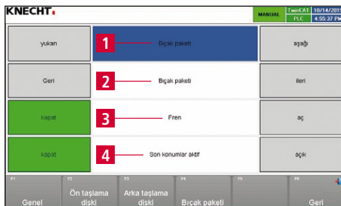
Resim 8-12 Manuel fonksiyonlar "Bıçak paketi"
