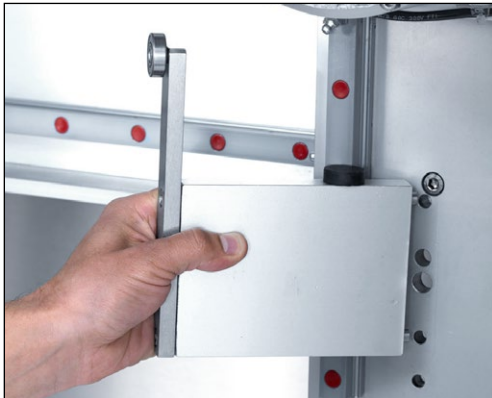
Resim 7-4 Z bağlantısını monte etme
