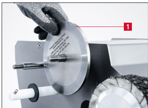
Фиг. 6-7 Монтиране на CBN заточващ диск
