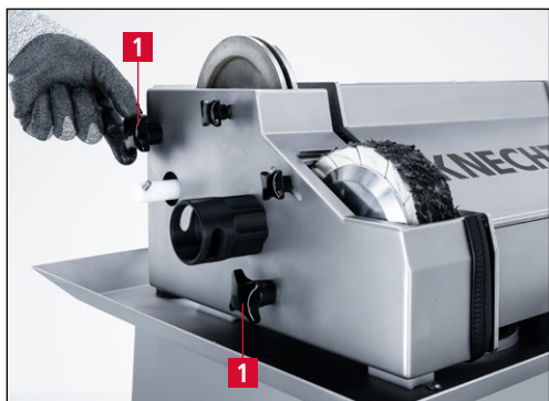
Фиг. 6-12 Демонтиране на предпазен капак
