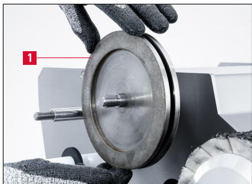
Фиг. 6-9 Монтиране на втори CBN заточващ диск
