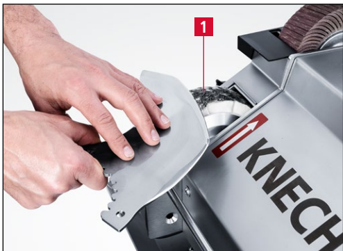
Фиг. 7-22 Премахване на заусенъци на кутер нож с помощта на полиращ диск и полиране
