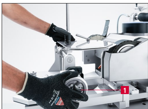
Фиг. 9-15 Придвижване на устройството за заточване към заточващата лента
