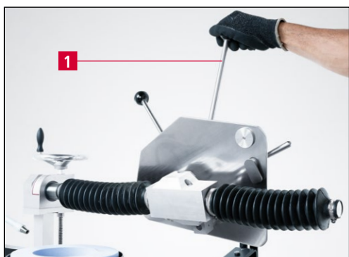
Фиг. 7-8 Завъртане на заточващата плоча надолу
