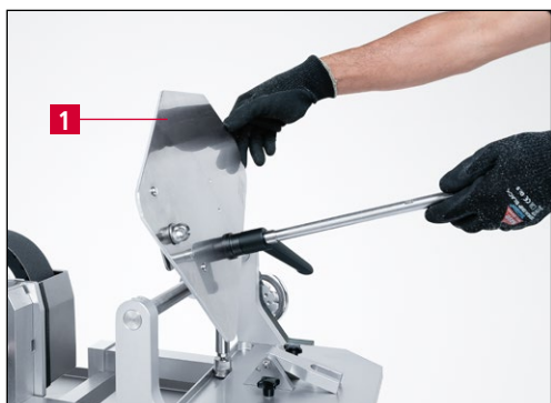
Фиг. 9-8 Завъртане на заточващата плоча надолу
