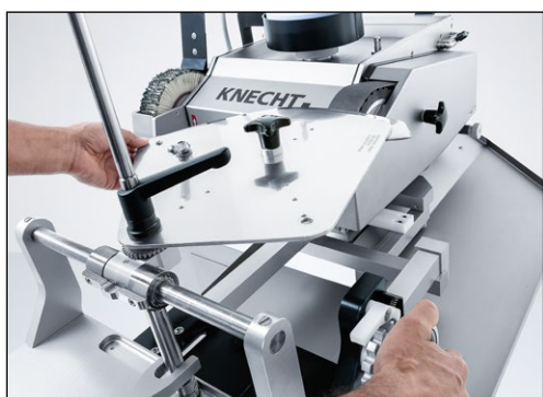
Фиг. 9-42 Придвижване на устройството за заточване към заточващата лента
