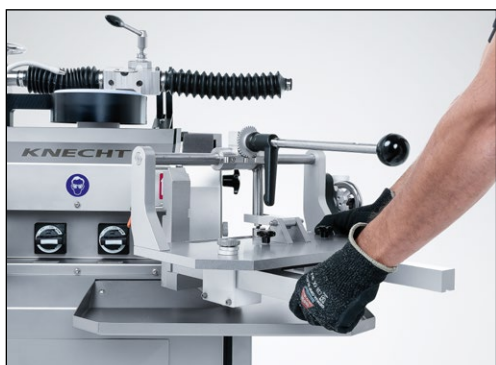
Фиг. 8-2 Завъртане на HV 262 в работна позиция
