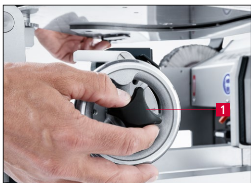
Фиг. 9-41 Разхлабване на кръстата ръкохватка
