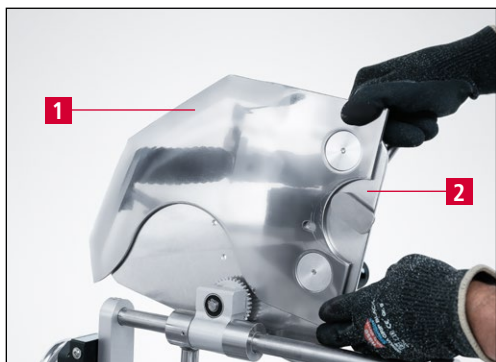
Фиг. 9-9 Затягане на ножа върху заточващата плоча
