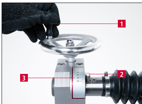
Фиг. 7-45 Настройване на ъгъла на заточване
