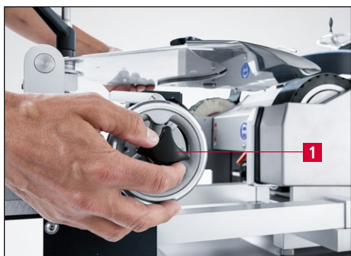
Фиг. 9-48 Връщане на устройството за заточване
