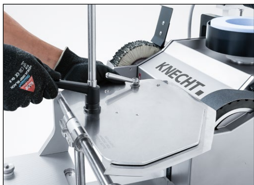
Фиг. 9-17 Подравняване на ножа към заточващата лента
