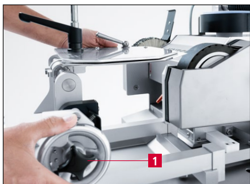
Фиг. 9-24 Връщане на устройството за заточване
