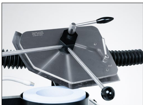
Фиг. 7-11 Завъртане на заточващата плоча напред
