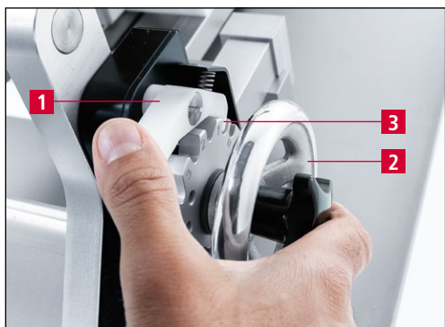
Фиг. 9-20 Поставяне на устройството за заточване в позиция за заточване „1“
