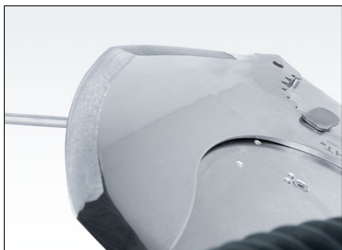
Фиг. 7-50 Кутер нож с предварително изпъкнало заточване
