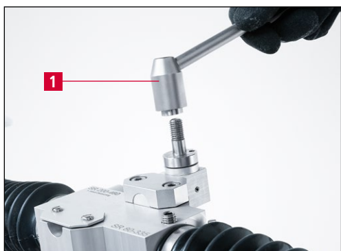
Фиг. 7-4 Сваляне на затягащия лост
