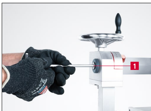
Фиг. 6-1 Свлячане на въртящото се рамо
