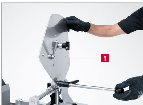
Фиг. 9-35 Завъртане на заточващата плоча назад в блокировката против развъртане
