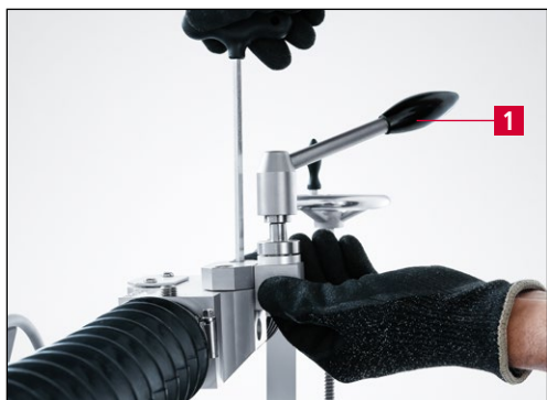
Фиг. 7-1 Монтиране на неподвижната захващаща глава
