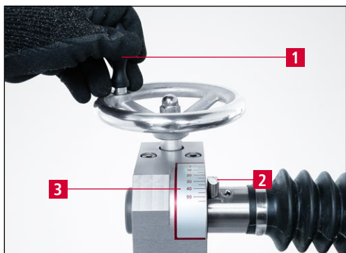
Фиг. 7-18 Настройване на ъгъла на заточване
