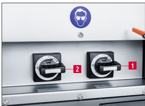
Фиг. 9-19 Включване на заточващата машина и устройството за охлаждаща течност
