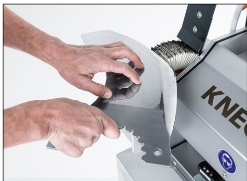
Фиг. 9-22 Премахване на заусенъци на кутер нож с помощта на ламелна четка и полиране
