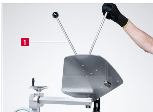
Фиг. 7-10 Завъртане на заточваща плоча надолу
