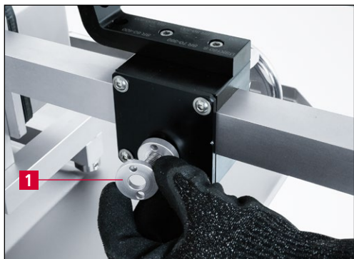
Фиг. 9-1 Разделителни дискове за настройване на ъгъл на заточване
