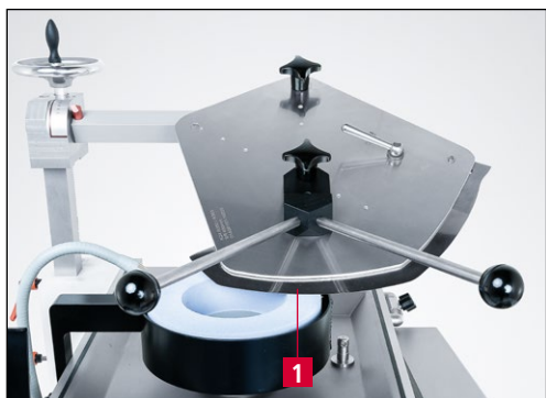
Фиг. 7-13 Позиция на ножа върху заточващия диск
