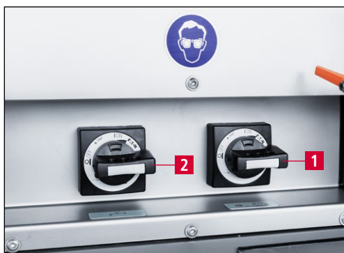
Фиг. 9-15 Включване на заточваща машина и устройство за охлаждаща течност
