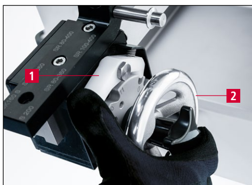
Фиг. 9-12 Поставяне на устройството за заточване в позиция за настройване "0"
