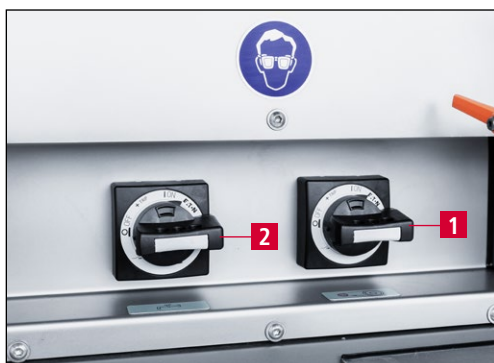
Фиг. 7-17 Включване на заточваща машина и устройство за охлаждаща течност
