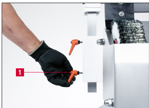
Фиг. 7-14 Настройване на нож върху центъра на заточващия диск
