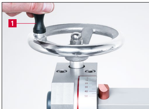
Фиг. 7-19 Намаляване на ъгъла на заточване (изпъкнало заточване)
