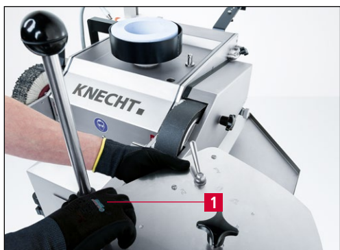
Фиг. 9-5 Настройване на диапазон на завъртане
