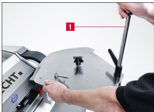
Фиг. 9-21 Завъртане на кутер нож към следващия режещ сегмент и заточване
