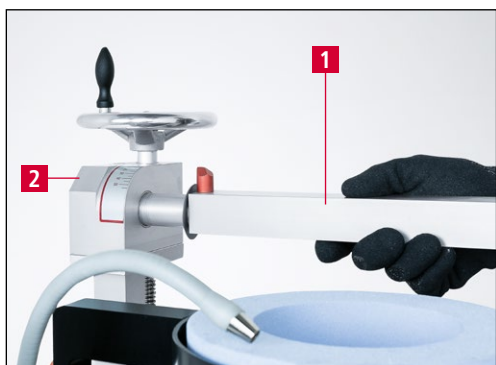
Фиг. 6-2 Монтиране на въртящо се рамо HV 207
