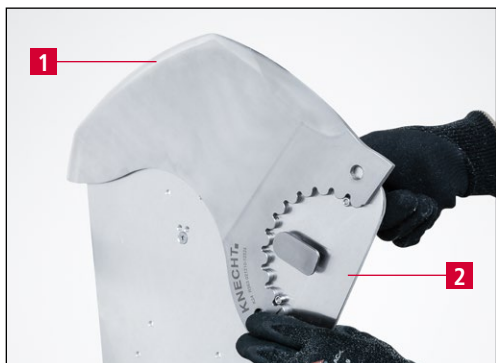
Фиг. 9-8 Затягане на нож върху заточващата плоча
