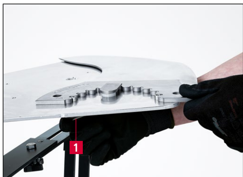
Фиг. 7-12 Фиксиране на нож върху заточваща плоча
