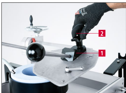
Фиг. 7-9 Монтиране на заточващ лост върху поемащ болт
