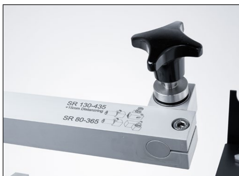
Фиг. 7-1 Проверка на положението на поемащата глава
