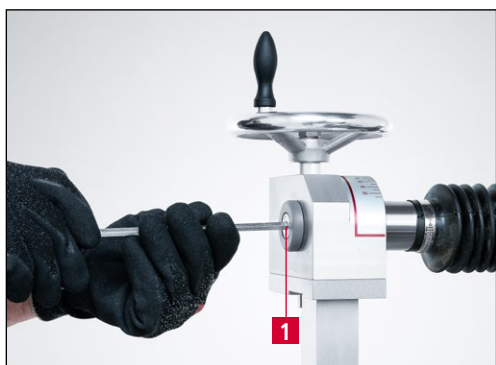
Фиг. 6-1 Свляне на универсално заточващо рамо HV 203
