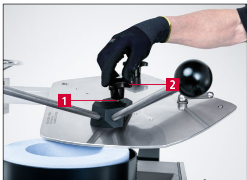
Фиг. 7-8 Монтиране на заточващ лост на заточваща плоча
