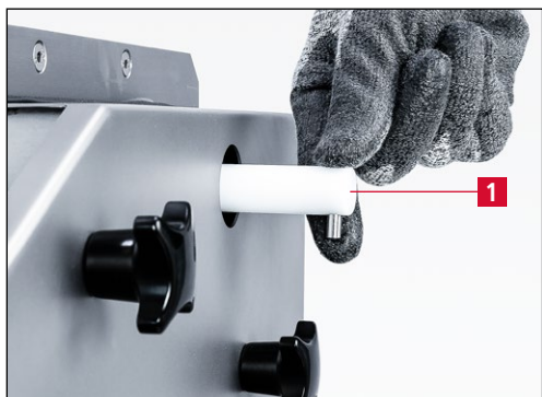
Фиг. 7-57 Фина настройка на подаването на охлаждаща течност
