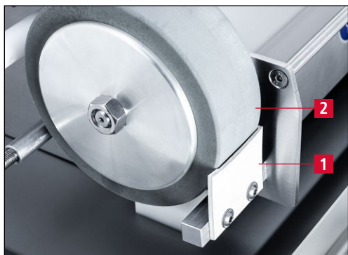
Фиг. 7-33 Позициониране на стъргалката
