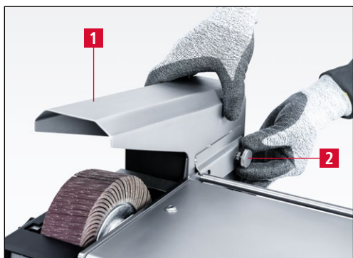
Фиг. 7-64 Сваляне на предпазителя срещу пръски
