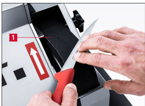
Фиг. 7-2 Предварително заточване на ръчни ножове
