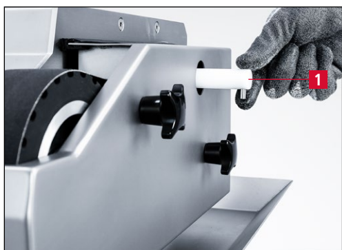
Фиг. 6-4 Дозирание на подаването на охлаждаща течност
