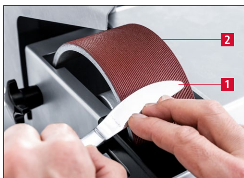
Фиг. 7-19 Профилиране на трапезни ножове
