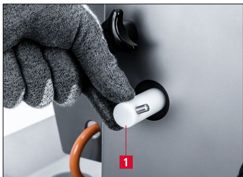
Фиг. 7-63 Фина настройка на подаването на охлаждаща течност
