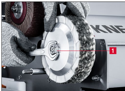
Фиг. 7-48 Освобождаване на полиращия диск
