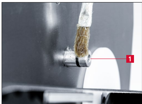
Фиг. 7-60 Смазване на накрайника за охлаждаща течност
