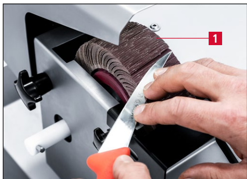
Фиг. 7-3 Фино заточване на ръчни ножове
