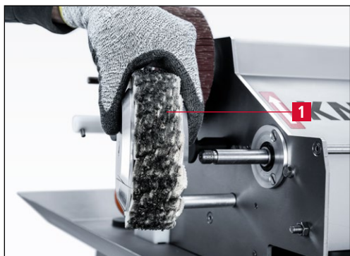
Фиг. 7-49 Сваляне на полиращия диск и замяна с нов
