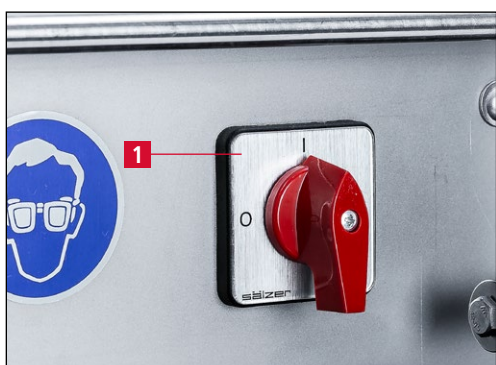
Фиг. 7-62 Включване на заточващата машина
