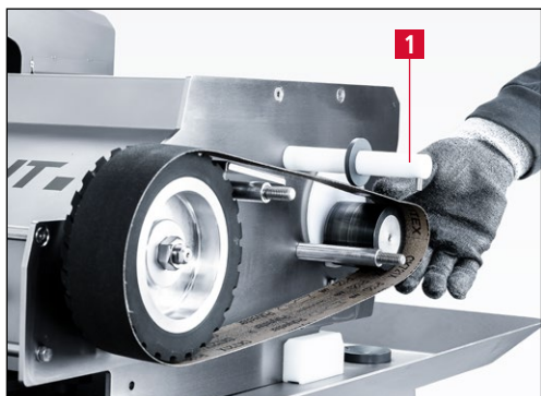
Фиг. 7-41 Поставяне на заточващата лента
