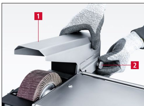
Фиг. 7-50 Сваляне на предпазителя срещу пръски
