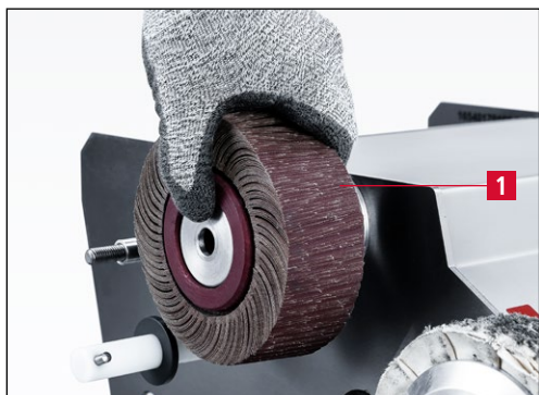
Фиг. 7-53 Сваляне на ламелното заточващо колело и замяна с ново
