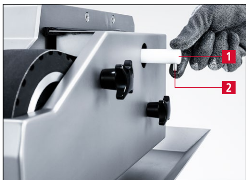
Фиг. 7-55 Настройване на водната дюза
