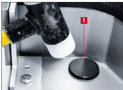
Фиг. 7-25 Отстраняване на капачката
