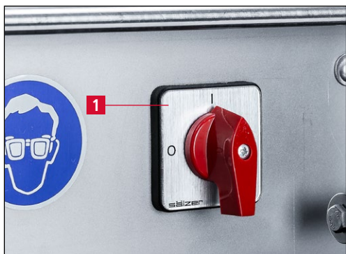
Фиг. 7-44 Включване на заточващата машина
