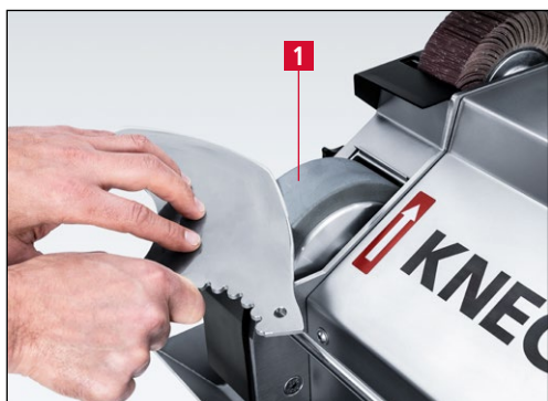
Фиг. 7-38 Премахване на заусенъците от ножа върху диска за мокро загладане
