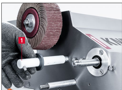
Фиг. 7-29 Поставяне на водната дюза
