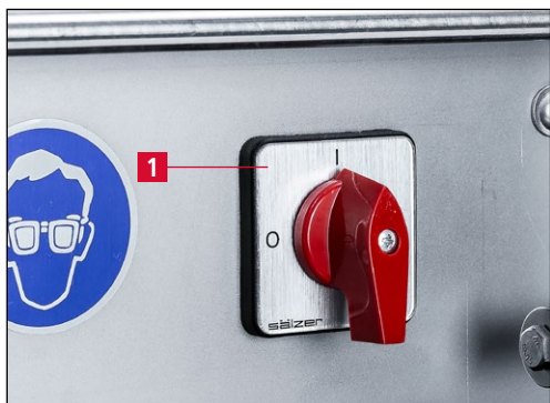
Фиг. 7-36 Включване на заточващата машина
