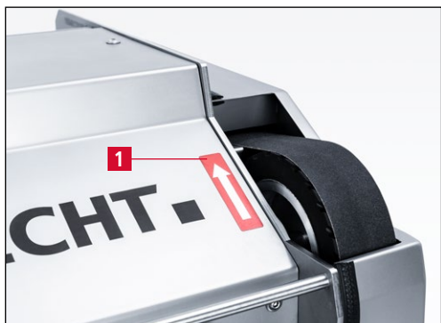
Фиг. 6-3 Проверка на посоката на въртене
