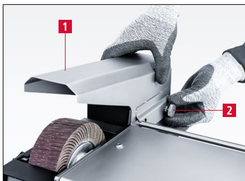
Фиг. 7-12 Сваляне на предпазителя срещу пръски
