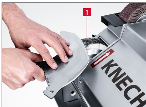
Фиг. 7-9 Премахване на заусенъци и полиране на кутер ножове
