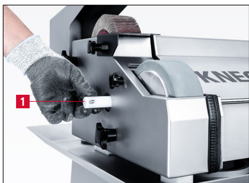
Фиг. 7-37 Фина настройка на подаването на охлаждаща течност
