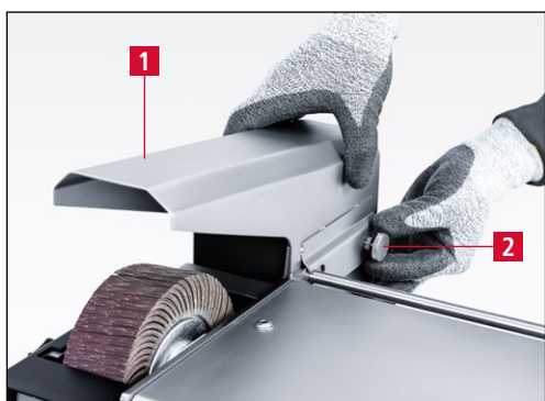
Фиг. 7-22 Сваляне на предпазителя срещу пръски
