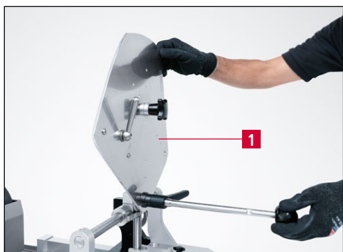
Obrázek 9-35 Otočení brusné desky dozadu do pojistky proti otáčení
