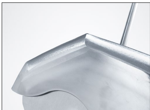
Obrázek 7-26 Konvexně předbroušený kutrový nůž
