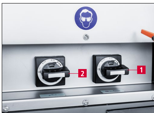
Obrázek 7-19 Zapnutí brusky a chladicí jednotky
