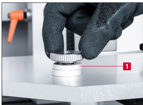
Obrázek 9-29 Distanční podložky pro nastavení úhlu broušení
