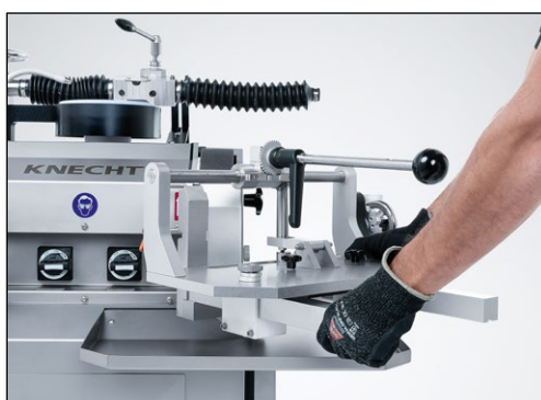
Obrázek 8-2 Otočení HV 262 do pracovní polohy
