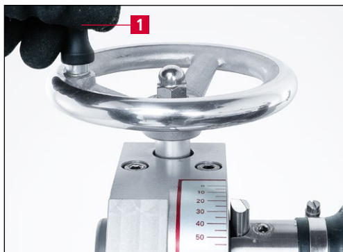
Obrázek 7-24 Zmenšení úhlu broušení (konvexní výbrus)
