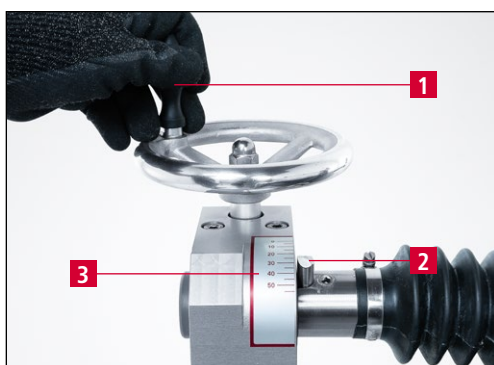
Obrázek 7-45 Nastavení úhlu broušení
