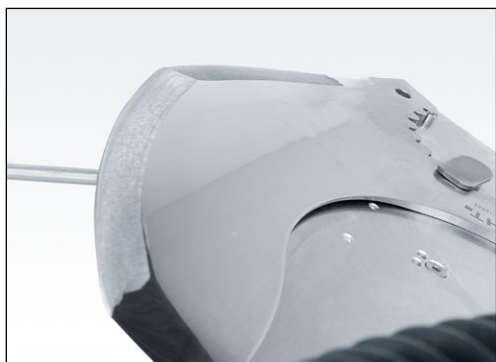
Obrázek 7-50 Konvexně předbroušený kutrový nůž
