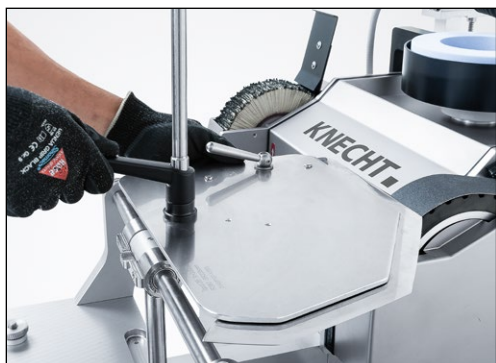
Obrázek 9-17 Vyrovnání nože na brusném pásu
