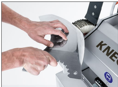
Obrázek 9-26 Odstraňování otřepů a leštění kutrových nožů na lamelovém kartáči
