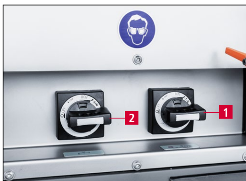
Obrázek 9-19 Zapnutí brusky a chladicí jednotky
