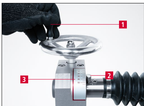
Obrázek 7-18 Nastavení úhlu broušení
