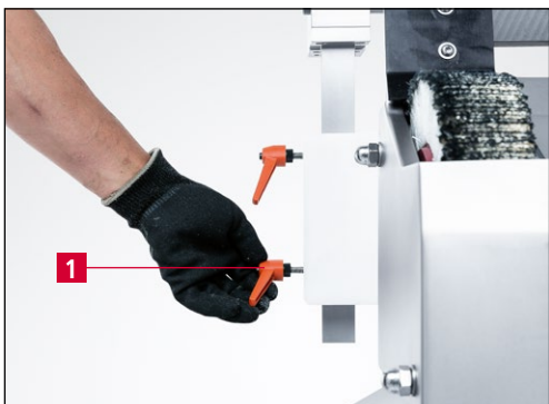
Obrázek 7-13 Nastavení nože na střed brusného kotouče
