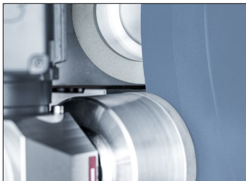
Bild 7-37 Kreismesser mittig zu den Schleifscheiben ausgerichtet
