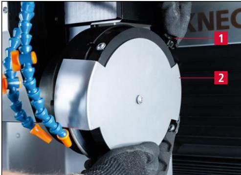
**Bild 7-76** Schutzhaube demontieren
