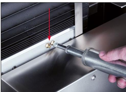
**Bild 9-8** Kreuzschlitten oben abschmieren
