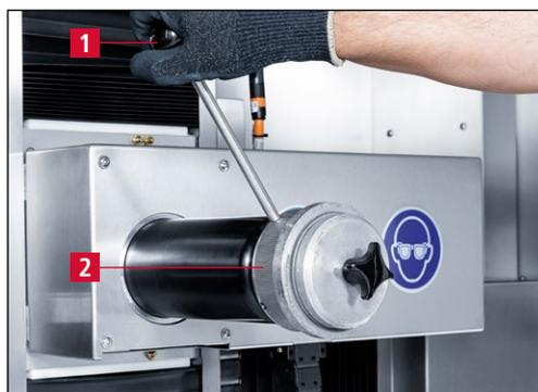
Bild 7-43 Spannmutter anziehen
