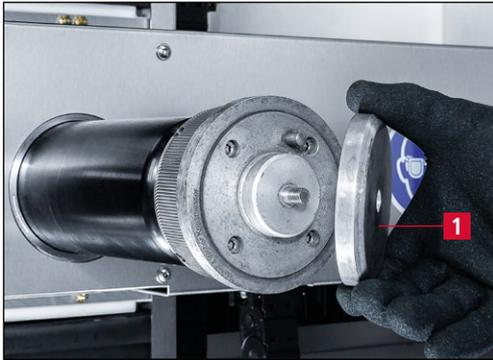
**Bild 7-63** Klemmflansch abnehmen
