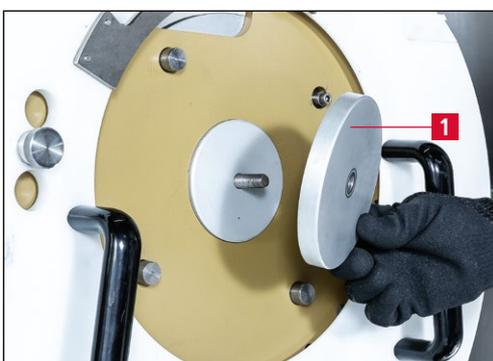
**Bild 7-30** Klemmflansch aufsetzen
