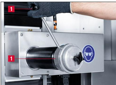
**Bild 7-61** Spannmutter anziehen
