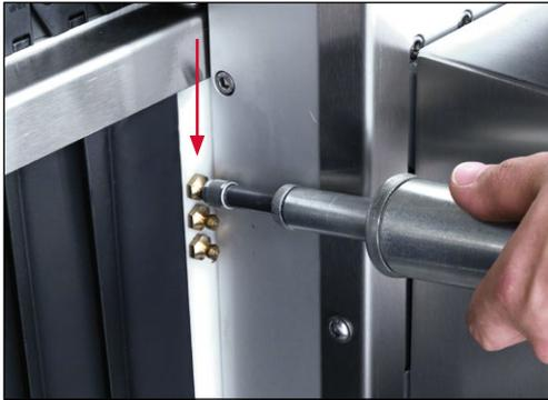
**Bild 9-9** Kreuzschlitten seitlich abschmieren
