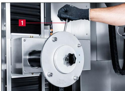
**Bild 7-7** Spannmutter anziehen
