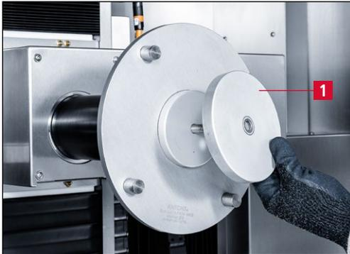
**Bild 7-28** Klemmflansch abnehmen
