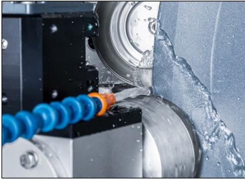
**Bild 7-51** Kreismesser schleifen
