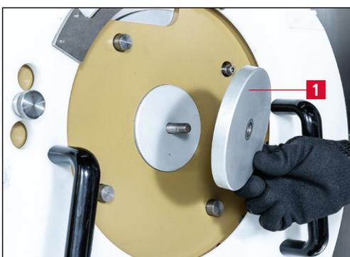
**Bild 7-11** Klemmflansch aufsetzen
