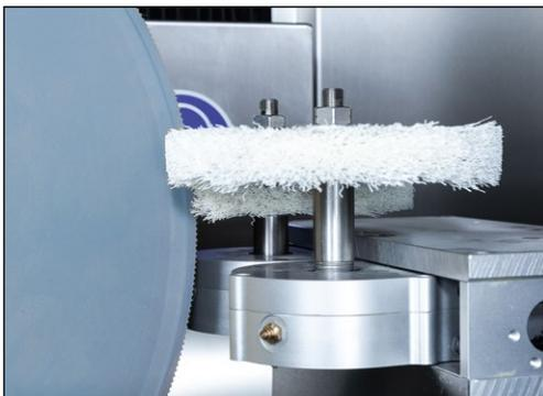
**Bild 7-70** Kreismesser polieren
