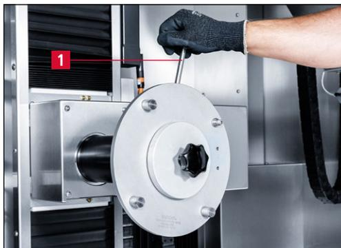
**Bild 7-26** Spannmutter anziehen
