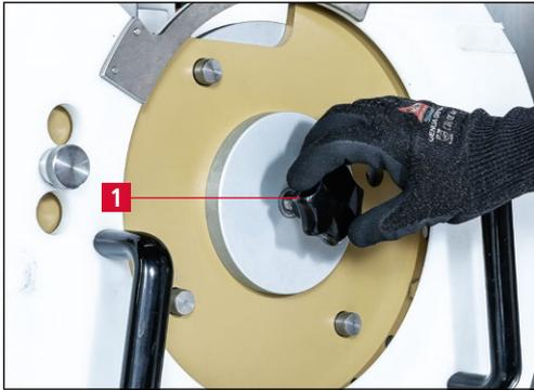
**Bild 7-12** Klemmflansch festschrauben
