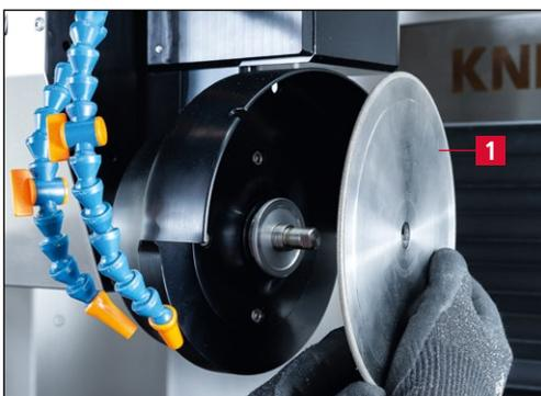
**Bild 7-78** Profilscheibe wechseln
