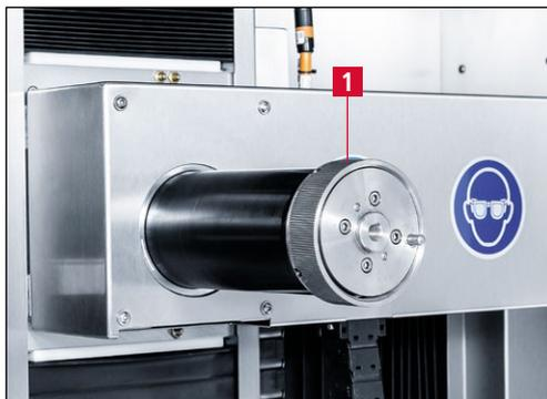
Bild 7-41 Spannmutter
