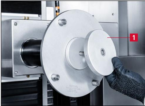
**Bild 7-9** Klemmflansch abnehmen
