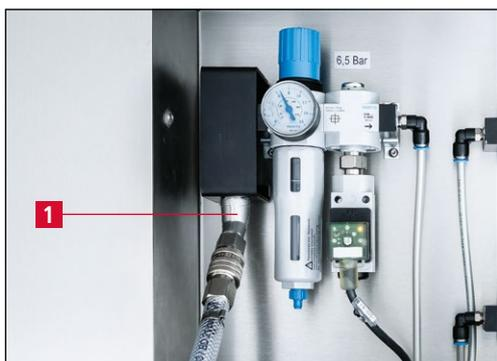
Bild 6-2 Druckluftanschluss
