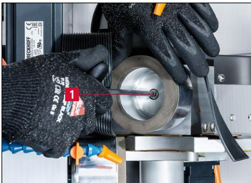
Bild 7-74 Schleifscheiben wechseln
