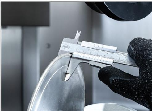
Bild 7-56 Dicke der Profilscheibe messen
