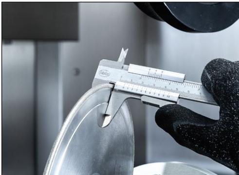
Bild 7-21 Dicke der Profilscheibe messen
