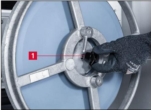
**Bild 7-66** Klemmflansch festschrauben
