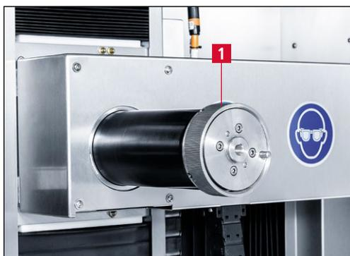
Bild 7-24 Spannmutter
