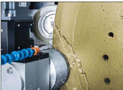
**Bild 7-16** Sichelmesser schleifen und entgraten
