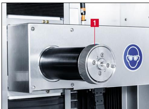
Bild 7-59 Spannmutter
