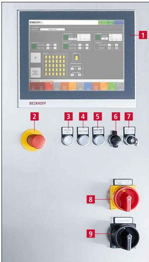
Bild 3-5 Bedienpult Schleifmaschine
