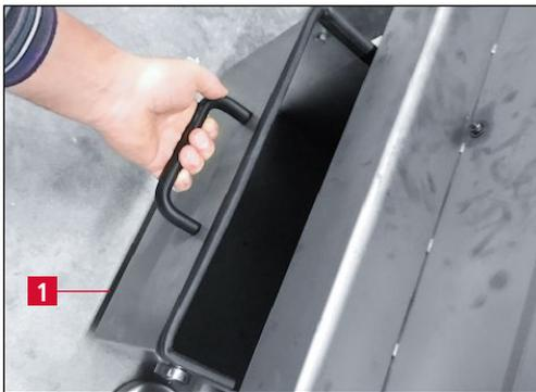
Bild 9-3 Schublade Absauganlage
