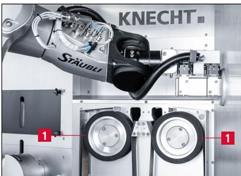
Bild 7-7 Nass-Schleifband wechseln
