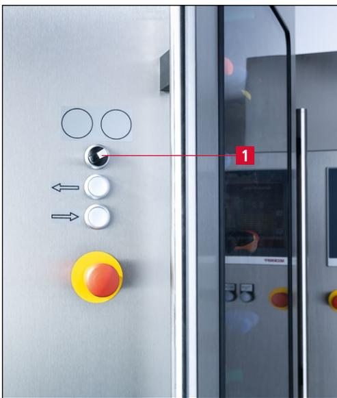
Bild 7-1 Bedienpult Trommelmagazin
