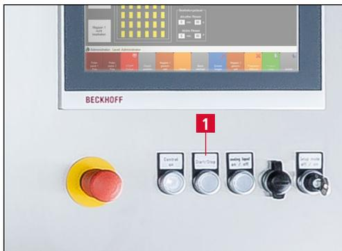
Bild 7-5 Bedienpult Schleifmaschine
