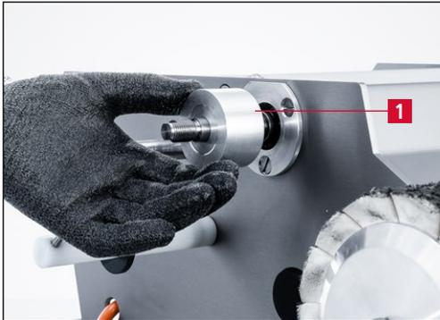
**Bild 6-6** Spannflansch 30 mm aufstecken
