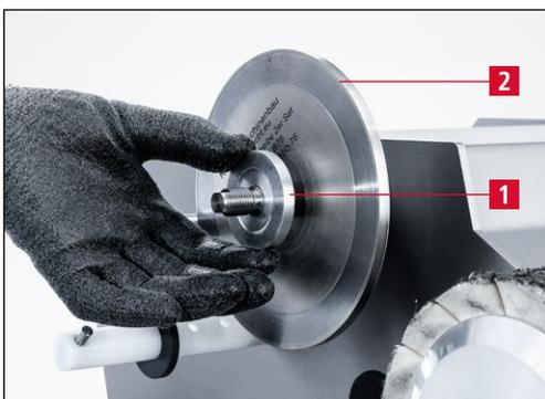
**Bild 6-8** Zwischenflansch 6,5 mm aufstecken
