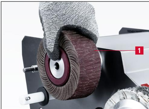
**Bild 6-4** Lamellenschleifrad abnehmen
