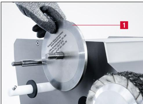
**Bild 6-7** CBN-Schleifscheibe montieren
