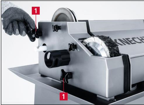
**Bild 6-12** Schutzhaube montieren
