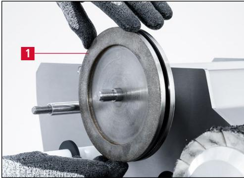
**Bild 6-9** Zweite CBN-Schleifscheibe montieren
