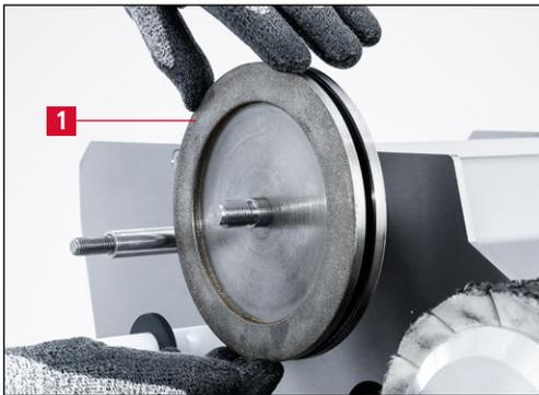
*Zweite CBN-Schleifscheibe (6-9/1) bis zum Zwischenflansch (6-8/1) auf die Schleifspindel schieben.*
