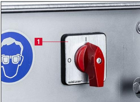
Bild 7-1 Schleifmaschine einschalten
