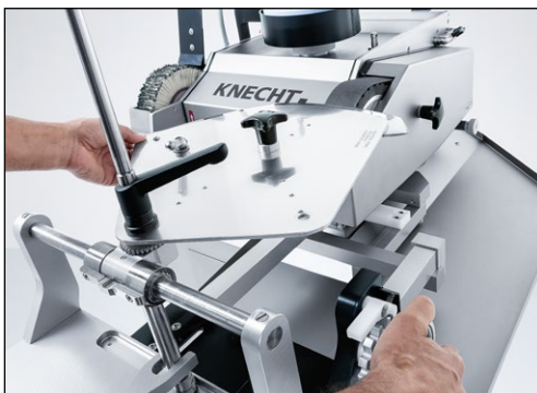
Bild 9-42 Schleifeinrichtung zum Schleifband bewegen
