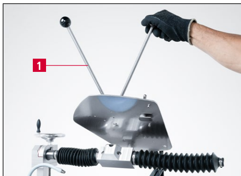
Bild 7-39 Schleifplatte nach hinten schwenken
