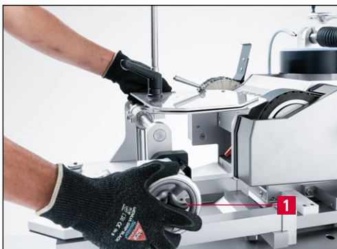
Bild 9-15 Schleifeinrichtung zum Schleifband bewegen
