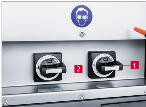
Bild 9-19 Schleifmaschine und Kühlmiteleinrichtung einschalten
