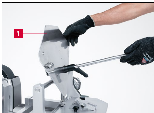
Bild 9-8 Schleifplatte nach hinten schwenken
