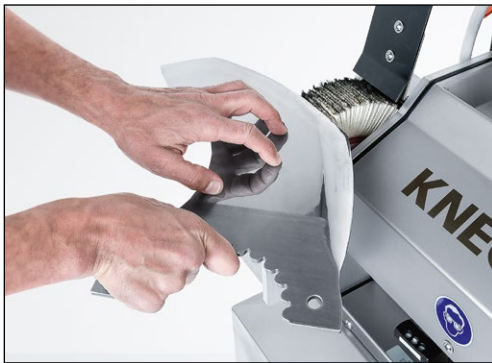
Bild 9-26 Kuttermesser auf der Lamellenbürste entgraten und polieren
