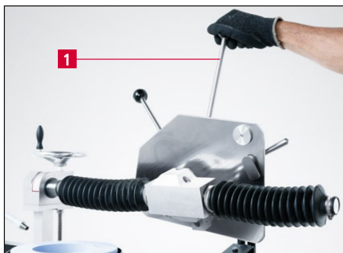
Bild 7-8 Schleifplatte nach hinten schwenken
