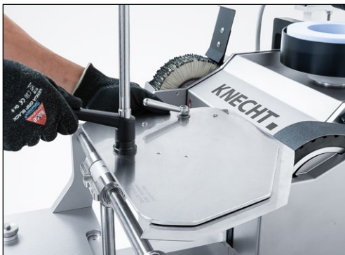
Bild 9-17 Messer am Schleifband ausrichten
