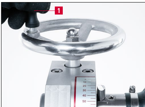
Bild 7-48 Schleifwinkel reduzieren (ballig schleifen)
