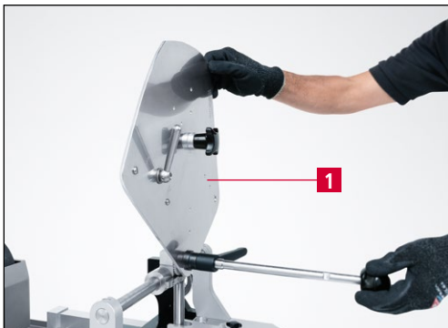
Bild 9-35 Schleifplatte nach hinten in die Verdrehsicherung schwenken
