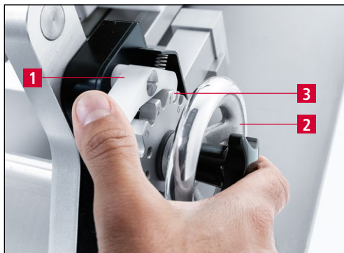
Bild 9-20 Schleifeinrichtung in Schleifposition „1“ bringen
