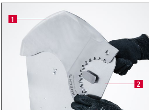
Bild 9-36 Messer auf Schleifplatte aufspannen
