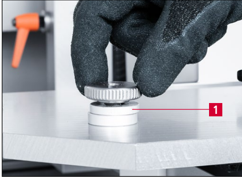
Bild 9-4 Distanzscheiben für die Schleifwinklereinstellung
