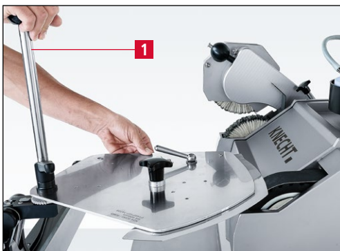
Bild 7-68 Kuttermesser auf nächstes Schneidensegment schwenken und schleifen
