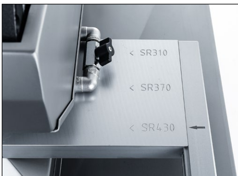
Bild 7-28 Eingestellte Position der Schleif- und Poliereinrichtung
