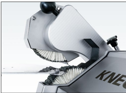
Bild 7-125 Distanz zwischen Lamellenbürsten ca. 20 mm
