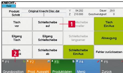
Nach dem Schleifen mit „Schleifscheibe auf“ (8-16/1) die Schleifscheibe nach oben fahren.
