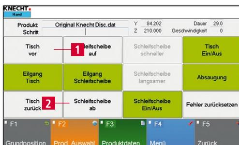
Bild 8-15 Tisch und Schleifscheibe in Arbeitsposition bringen
