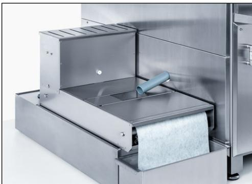
**Bild 6-1** Bandfilter-Kühlmitteleinrichtung befüllen
