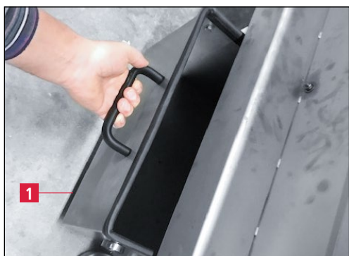
Billede 9-8 Skuffe i udsugningsanlægget
