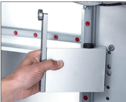
Imagen 7-4 Montar el acoplamiento Z
