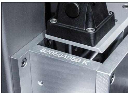
El número de la máquina (1-2) está en la placa de identificación (1-1) y delante a la izquierda de la máquina.
