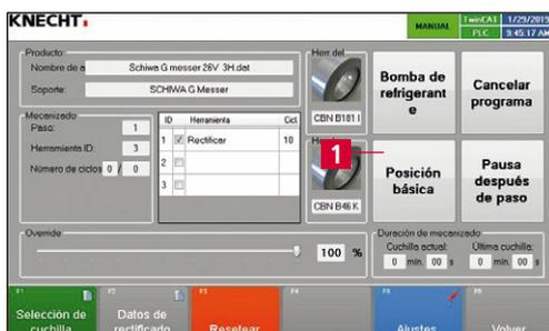
Imagen 7-7 Desplazar el disco de levas a la posición de cambio
