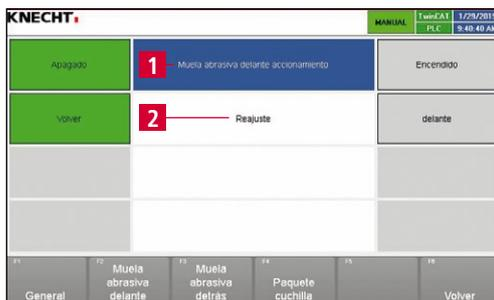
Imagen 8-10 Funciones manuales "Muela abrasiva delantera"
