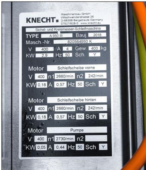
La placa de identificación (1-1) se encuentra en el lado derecho de la máquina, detrás del armario de distribución.
