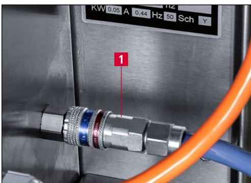
Imagen 6-2 Conexión de aire comprimido
