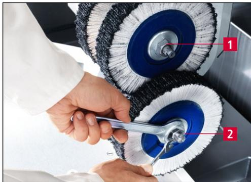
Imagen 7-22 Sustituir cepillos de láminas de la unidad de desbarbado
