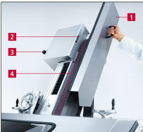
Imagen 7-17 Sustituir cinta abrasiva en húmedo
