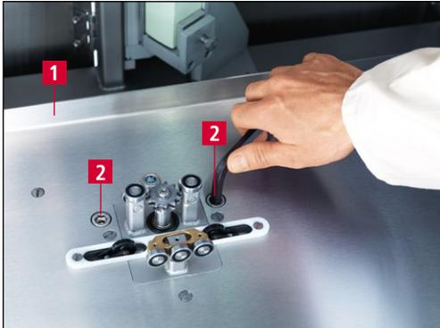
Imagen 9-7 Desmontar chapa de protección
