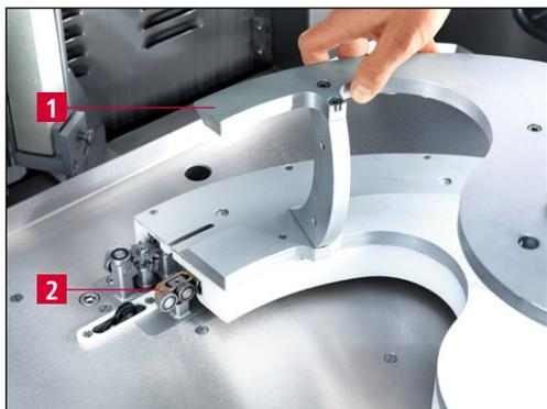
**Imagen 7-16** Empujar placa abrasiva copiadora hacia el carro guía
