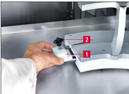
Imagen 7-14 Sustituir placa abrasiva copiadora
