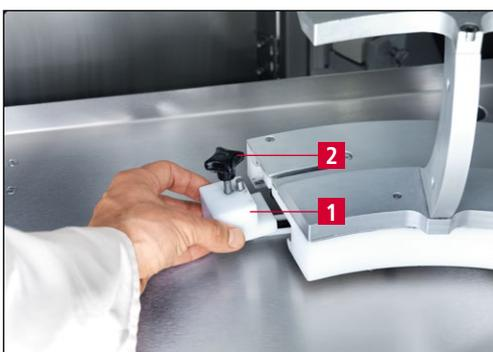
**Imagen 7-3** Montar el interruptor final del pitón
