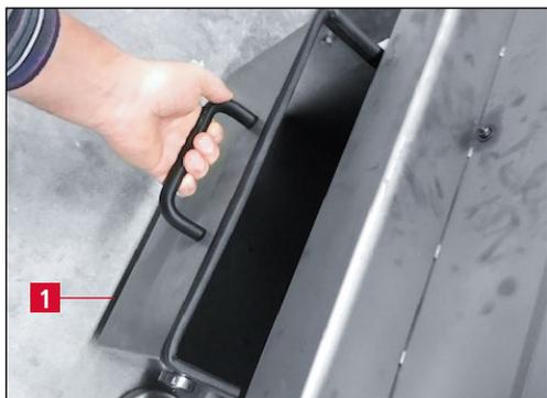
Imagen 9-3 Cajón del sistema de aspiración
