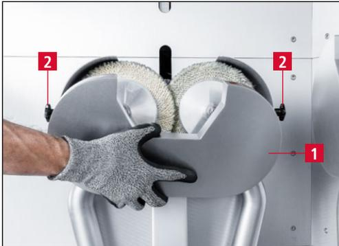
**Imagen 7-18** Cómo retirar la cubierta de protección
