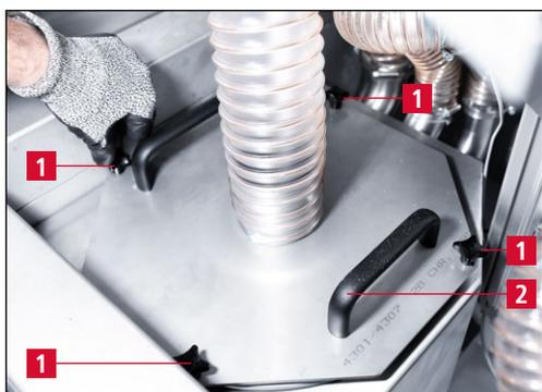
Imagen 9-4 Abrazadera del sistema de aspiración
