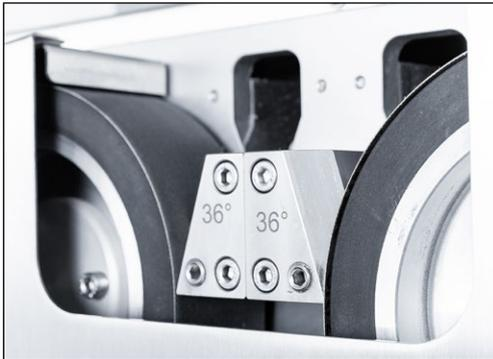
**Imagen 7-11** Ajuste de las cintas abrasivas húmedas
