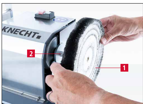
Imagen 7-14 Sustituir la muela de pulir
