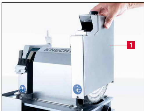
Imagen 7-12 Desmontar la cubierta de la muela de pulir
