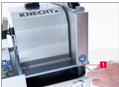
Imagen 7-11 Aflojar la cubierta de la muela de pulir
