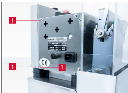
Imagen 7-10 Aflojar la cubierta de la muela de pulir
