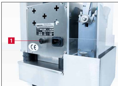
Imagen 7-16 Conexión para aspiradora industrial
