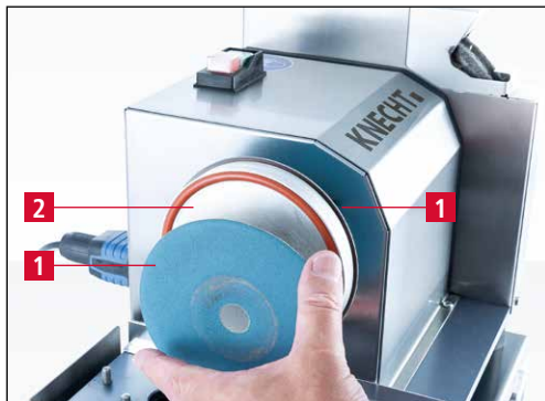
Imagen 7-8 Desmontar las muelas abrasivas usadas
