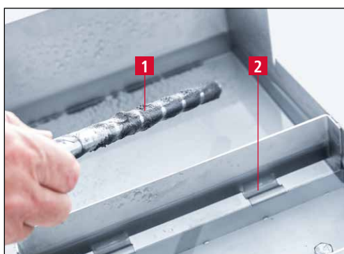
Imagen 6-1 Colocación de la barra magnética
