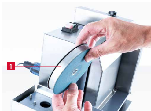
Imagen 7-9 Montar un nuevo par de muelas abrasivas
