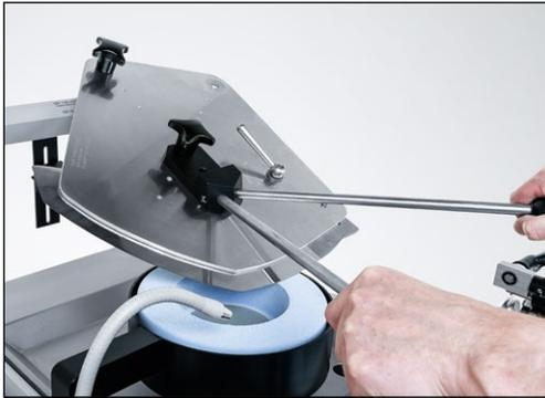
**Imagen 7-20** Girar el cúter hasta el siguiente segmento de filo y afilar
