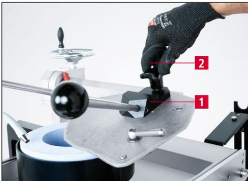
**Imagen 7-9** Montar la palanca de afilado en el perno de alojamiento
