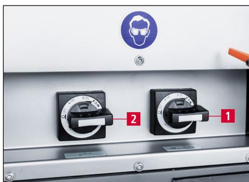
**Imagen 9-15** Encender la afiladora y el sistema de refrigerante
