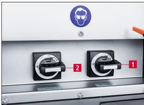
**Imagen 7-17** Encender la afiladora y el sistema de refrigerante
