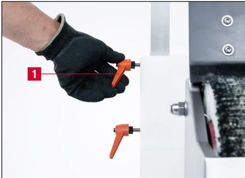
**Imagen 7-15** Soltar la palanca de sujeción
