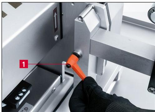
**Imagen 8-3** Bloquear el dispositivo para rectificar en la cinta
