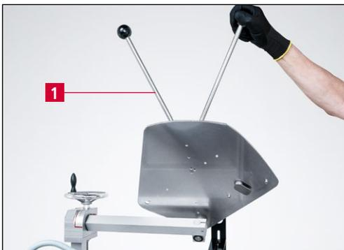
**Imagen 7-10** Girar la placa de afilado hacia atrás
