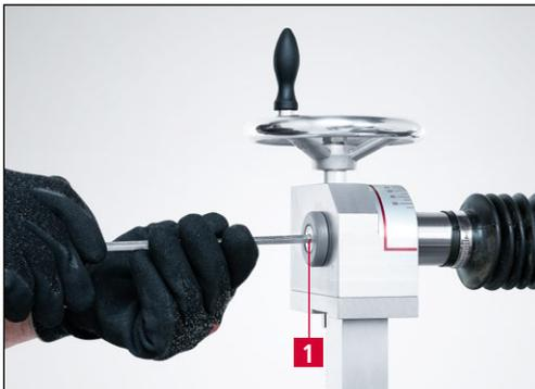
**Imagen 6-1** Extraer el brazo de afilado universal HV203
