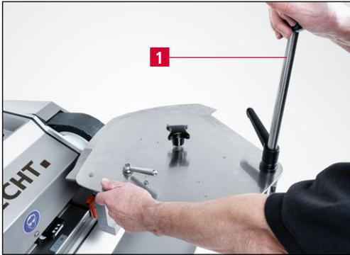
**Imagen 9-21** Girar el cúter hasta el siguiente segmento de filo y afilar
