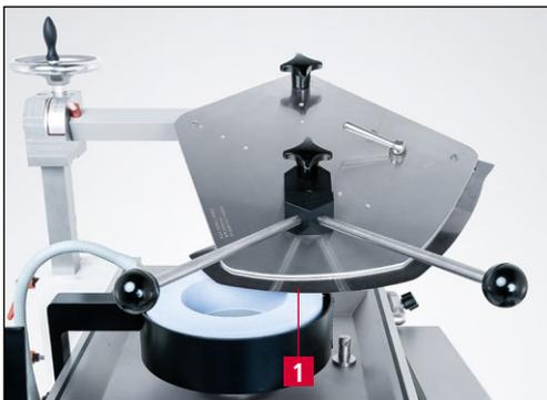
**Imagen 7-13** Posición de la cuchilla en la muela de afilado
