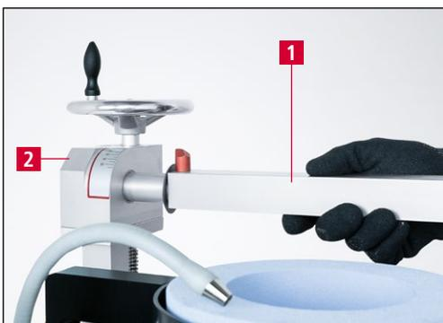
**Imagen 6-2** Montar el brazo giratorio HV 207
