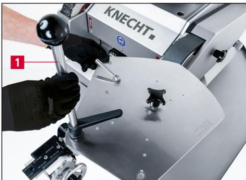
Imagen 9-4 Apretar la palanca de afilado
