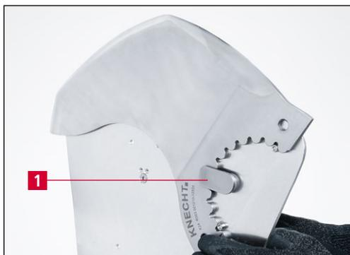
**Imagen 9-9** Bloquear la cuchilla en la placa de afilado
