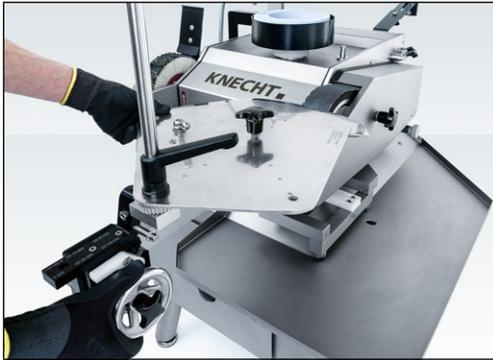
**Imagen 9-14** Mover el dispositivo para rectificar hacia la cinta abrasiva
