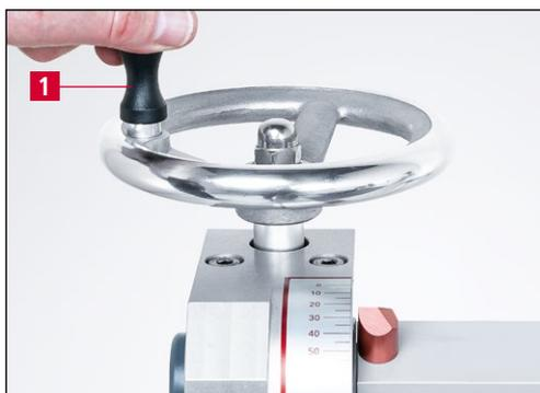
**Imagen 7-19** Reducir el ángulo de afilado (afilado convexo)
