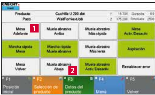
Imagen 8-15 Colocar la mesa y la muela abrasiva en posición de trabajo
