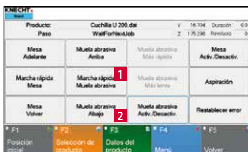
Imagen 7-9 Reavivar muela abrasiva
