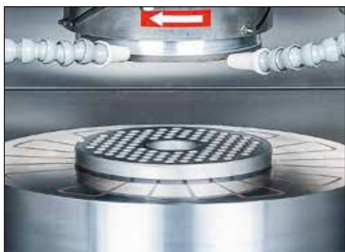
Imagen 7-5 Disco para picadora de carne sobre mesa circular
