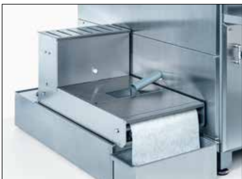
Imagen 6-1 Llenar dispositivo de refrigerante de filtro de banda
