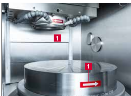
Imagen 6-4 Comprobar el sentido de giro
