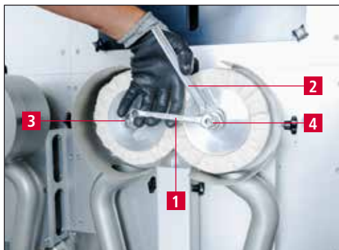
Kuva 7-15 Kiillotus- ja purseenpoistolaikkojen vaihtaminen
