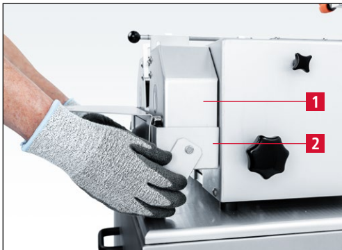
Kuva 7-95 Suojakuomun ja vesialtaan asentaminen
