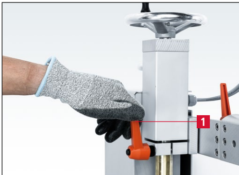
Kuva 7-61 Korkeussäädön lukitusvivun avaaminen
