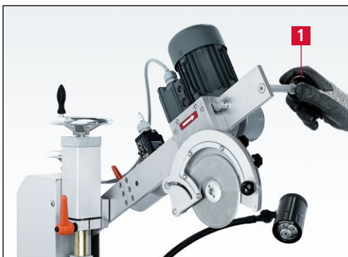
Kuva 7-70 Hiontalaitteen kääntäminen lepoasentoon
