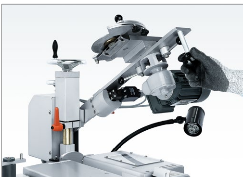
Kuva 7-73 Leikkuukiekon hiontalaitteen kääntäminen kiinnitysasentoon
