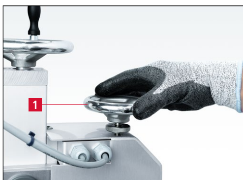
Kuva 7-67 Hienosäädön käsipyörän kääntämisen vastapäivään
