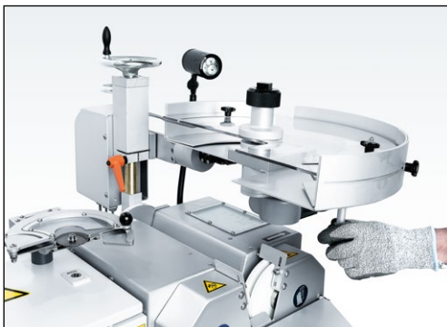
Kuva 7-10 Leikkuukiekon hiontalaite kiinnitysasennossa
