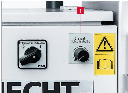
Kuva 7-76 Oikeanpuoleisten hiomalaikkojen pyörimisnopeuden säätäminen
