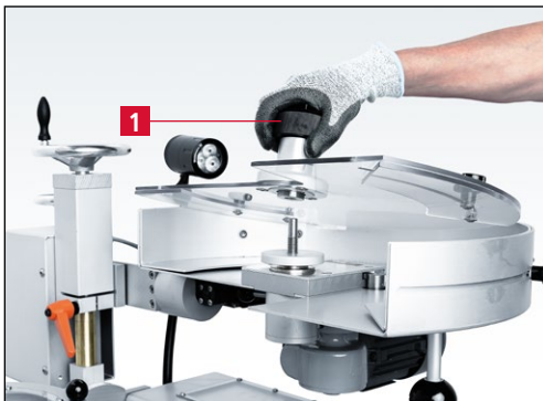
Kuva 7-11 Kiristysmutterin ja suojalevyn irrottaminen
