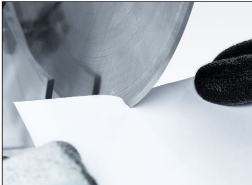
Kuva 7-32 Leikkuukiekon terävyyden tarkistaminen
