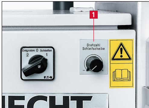
Kuva 7-37 Oikeanpuoleisten hiomalaikkojen pyörimisnopeuden säätäminen
