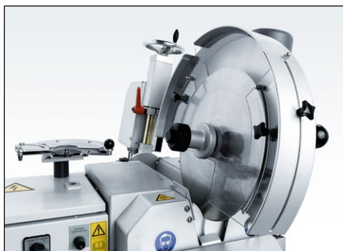
Kuva 7-39 Hiontalaitteen asettaminen vinoon
